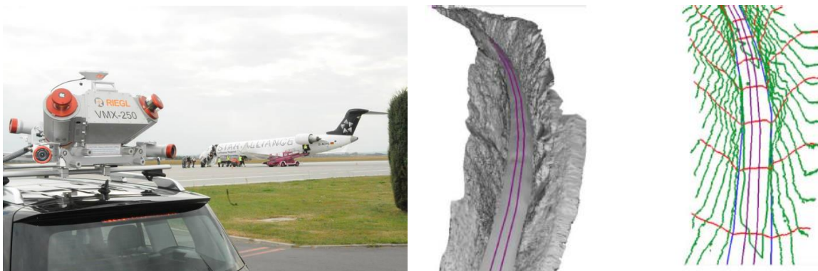
Figura 8. Escáner móvil RIEGL VMX-250 y detalle de nube de puntos y curvas de nivel de un tramo recorrido con un escáner laser móvil.
