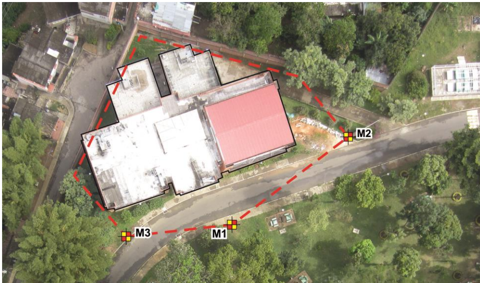
Figura 18. Poligonal para el proyecto.
