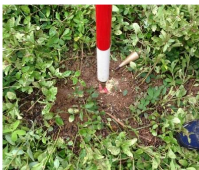
Figura 28. Muestra de una estaca-vértice de la poligonal.
