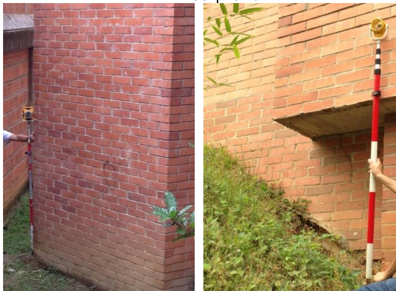
Figura 54. Errores en medición de aristas y esquinas por interferencia de la geometría del prisma
