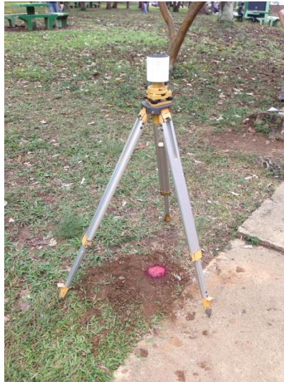
Figura 20. Reflector nivelado y localizado sobre uno de los puntos de amarre.
