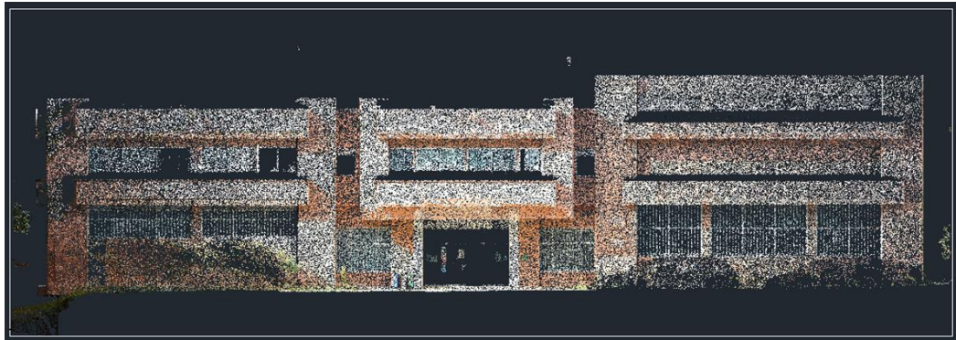
Figura 47. Fachada representada con nubes de puntos importada a AutoCad
