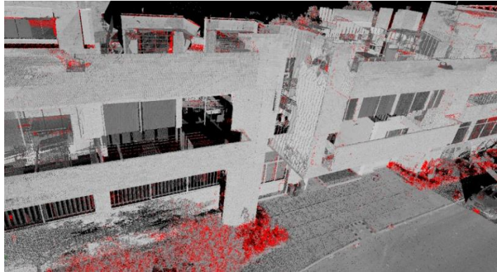
Figura 43. Puntos seleccionados con filtro por desviación.
