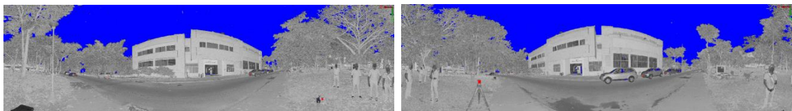
Figura 30. Visualización por valores de reflectancia de las posiciones de escaneo de la ScanPos001 a la ScanPos012.
