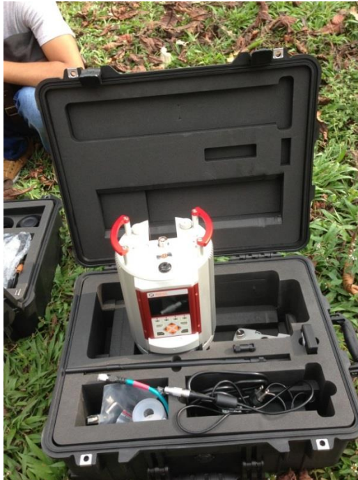
Figura 17. Escáner laser terrestre con su estuche y accesorios.
