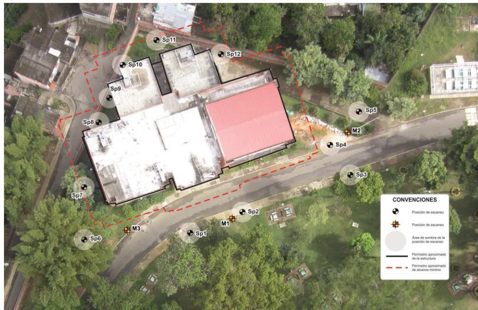
Figura 15. Distribución de las posiciones de escaneo y puntos de control
