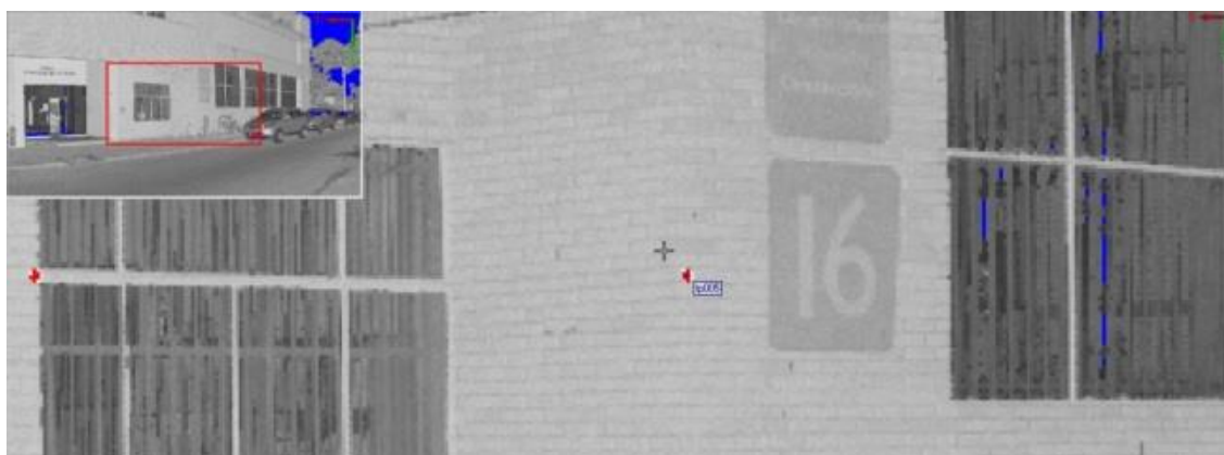
Figura 38. Nube de puntos con Tiepoint en un reflector.
