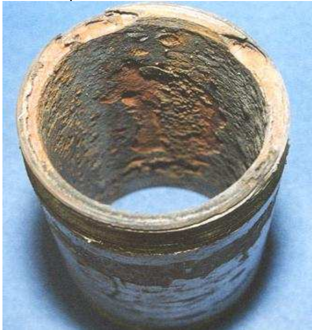
FIGURA 8. Tubing afectado por arena.
