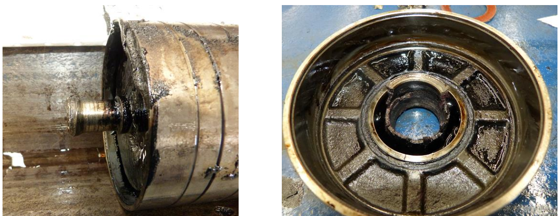
Ilustración 7. Ruptura del eje y etapa cercana al área de la fractura
