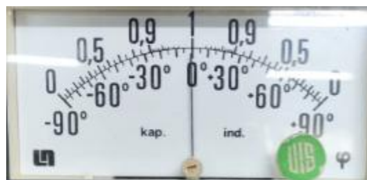
Figura 13. Aguja indicadora del cosenofimetro
