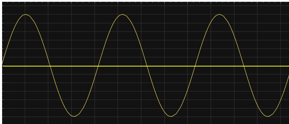
Figura 41. Onda senoidal a la salida del transformador
