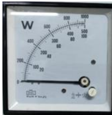
Figura 17. Aguja indicadora del vatímetro
