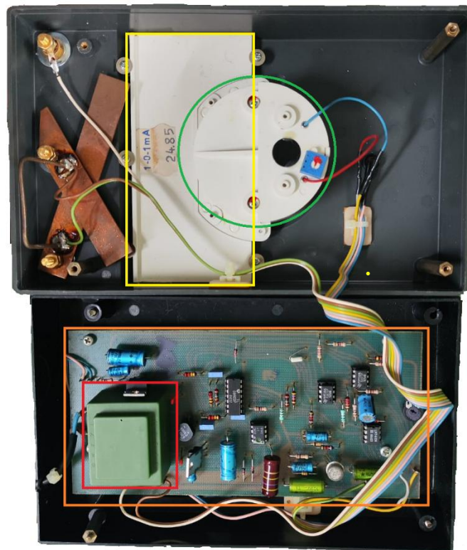
Figura 11. Elementos internos del cosenofímetro
