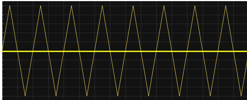
Figura 34. Onda triangular a la salida del generador
