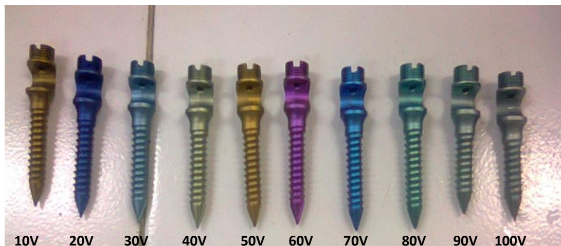
Figura 8. Carta de colores de anodizado a implementar en la empresa Quirúrgicos Especializados S.A.
