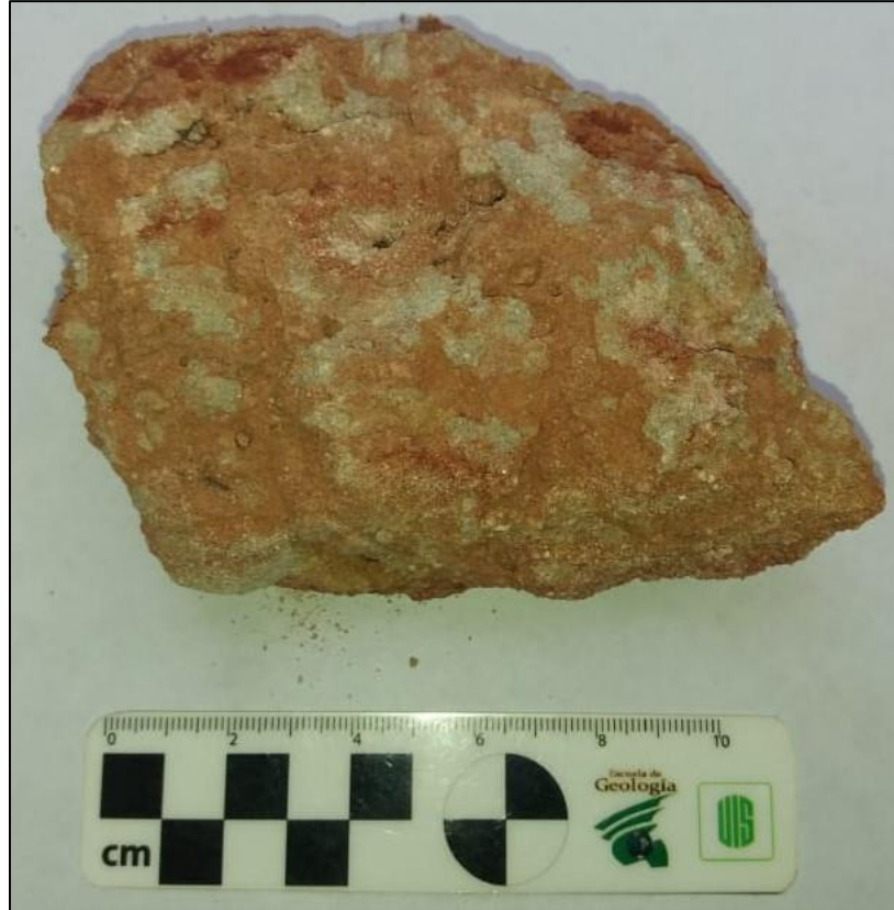
Figura 26. Fotografía de la muestra JD-2-1: arena gruesa ligeramente gravosa.
