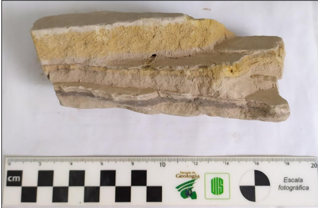
Figura 25. Fotografía de la muestra JD-2-4: arena fina lodosa.
