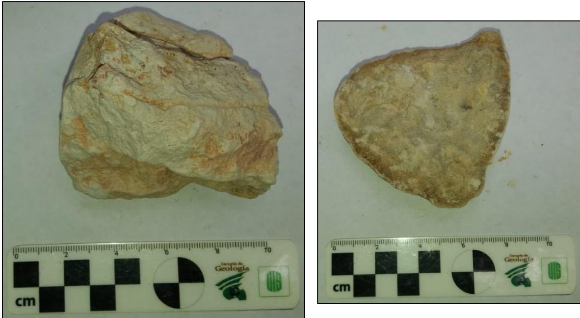
Figura 28. Fotografía de la muestra JD-2-3: arena media lodosa.
