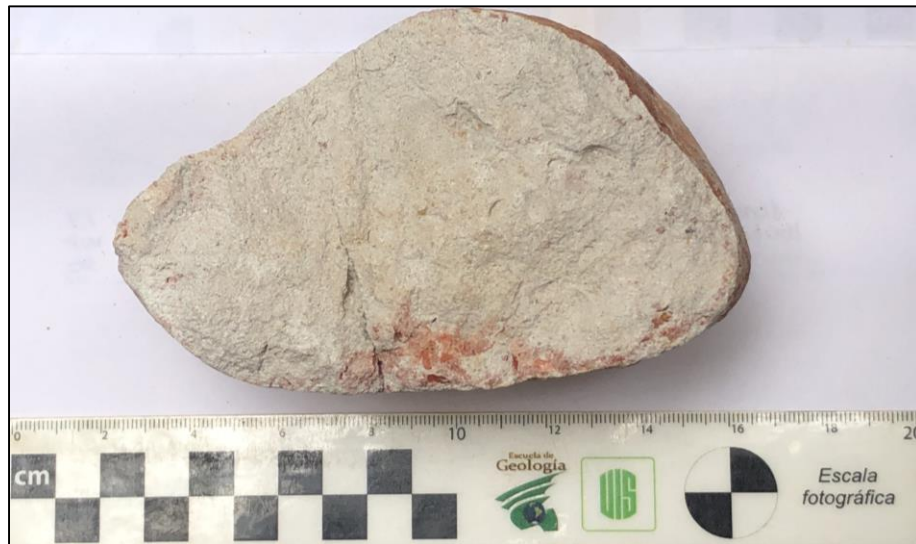
Figura 38. Fotografía de la muestra JD-3-6: arenisca media.
