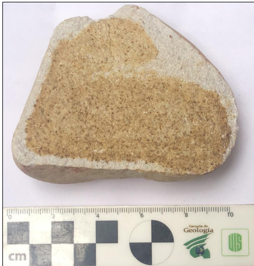
Figura 35. Fotografía de la muestra JD-3-3: arenisca gruesa ligeramente conglomerática.
