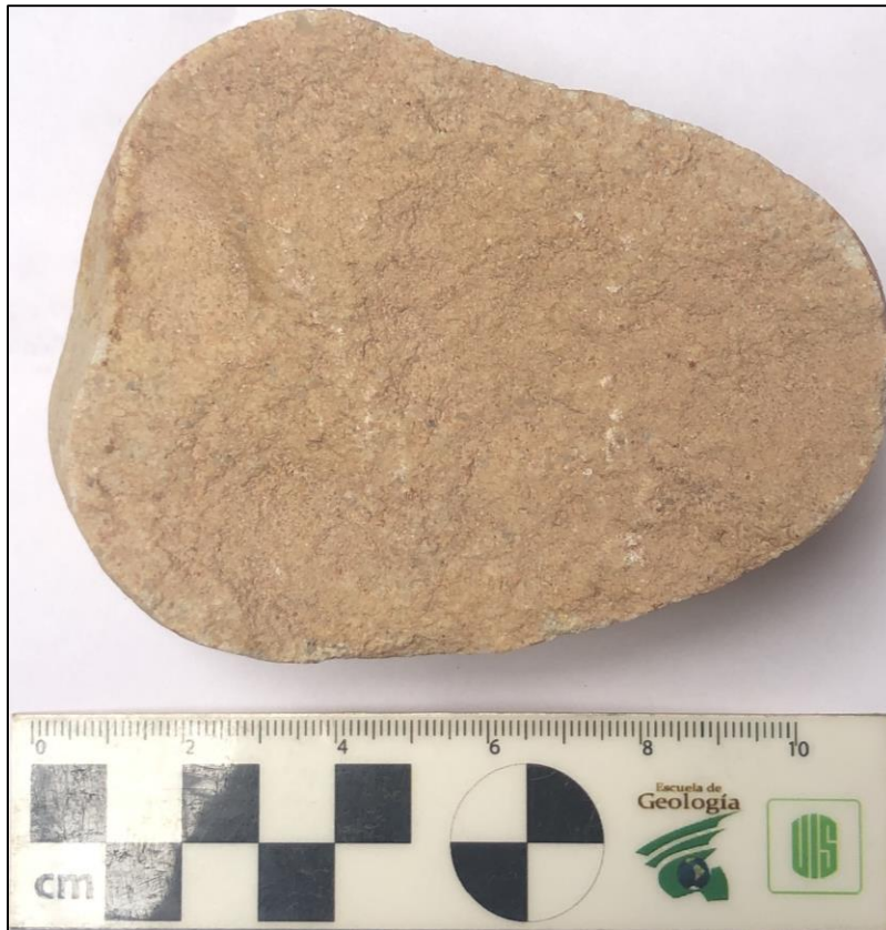
Figura 34. Fotografía de la muestra JD-3-2: arenisca gruesa ligeramente conglomerática.
