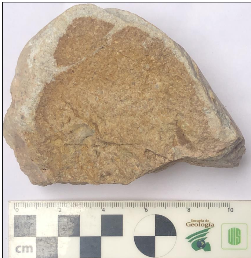
Figura 36. Fotografía de la muestra JD-3-4: arenisca muy gruesa conglomerática.
