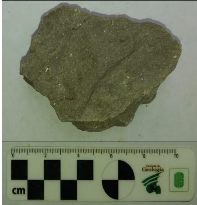
Figura 20. Fotografía de la muestra JD-1-2: arena lodosa.
