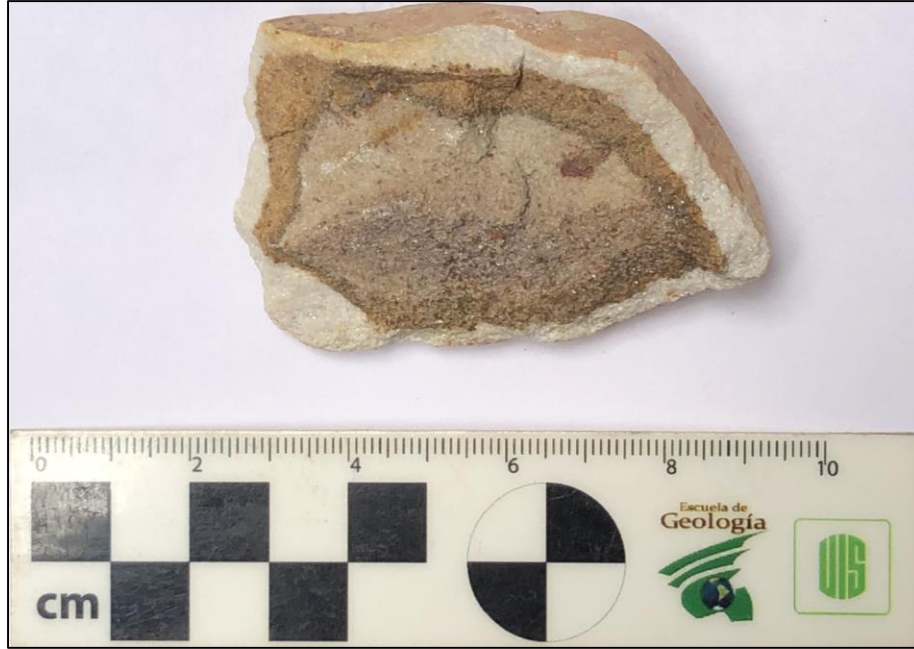
Figura 37. Fotografía de la muestra JD-3-5: arenisca media.
