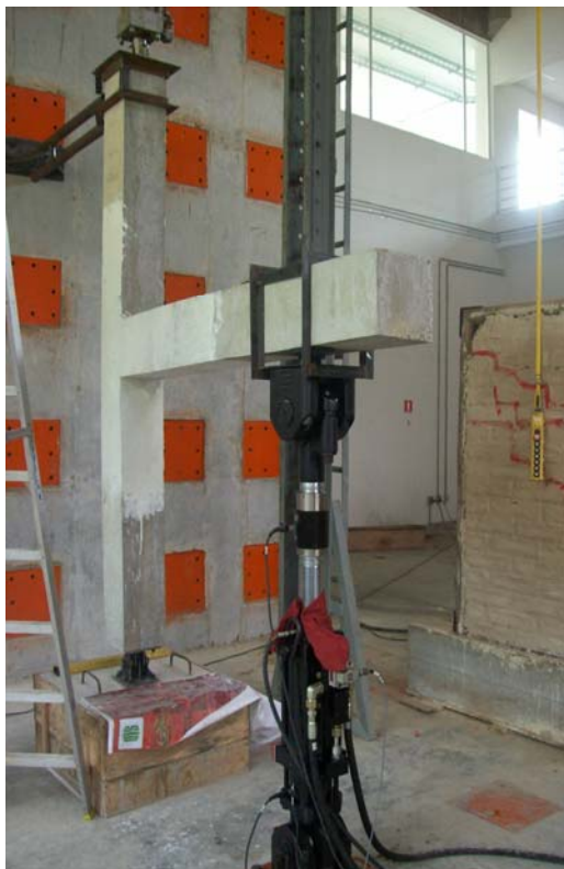
Imagen 14. Especimen listo para la prueba.
