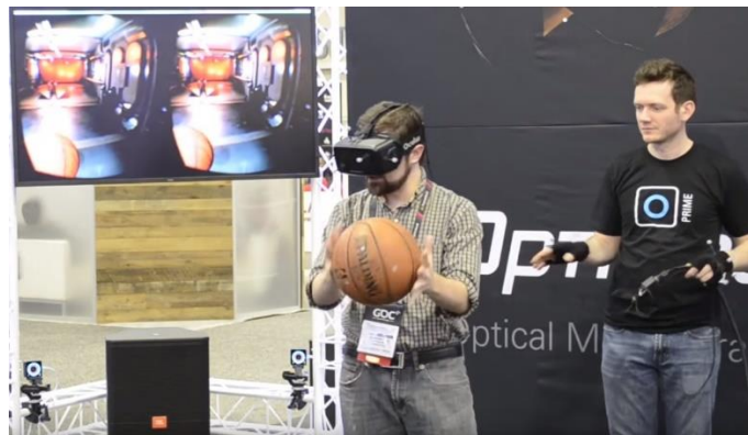
Ilustración 8 - Rastreo de HMD y objetos rígidos usando sistema Optitrack[14]
