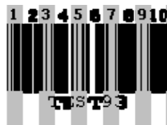
Figura 4.2. Ejemplo de la estructura de un código de barras que utiliza la simbología código 93.
