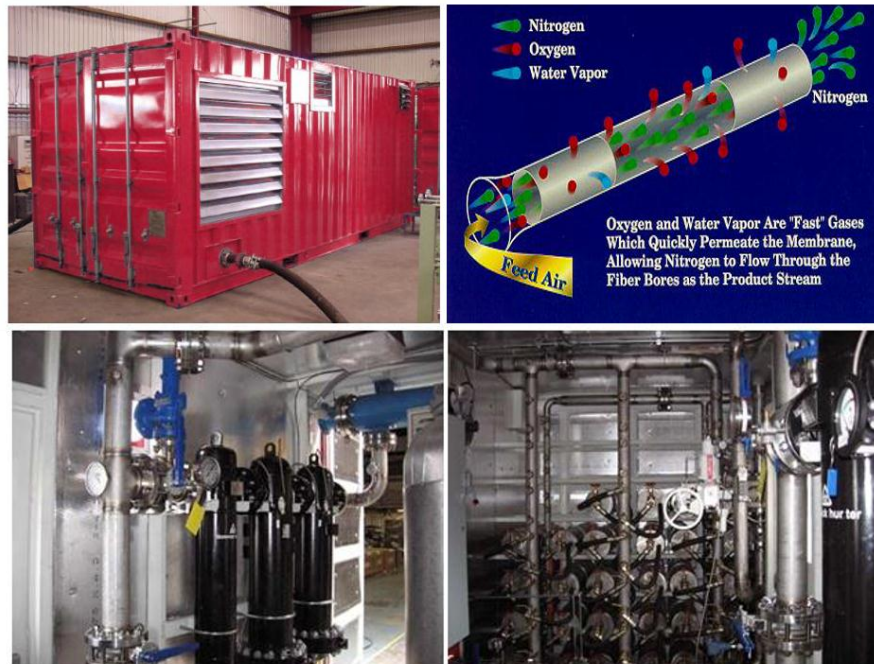
Figura 5. Unidad Generadora de Nitrógeno
