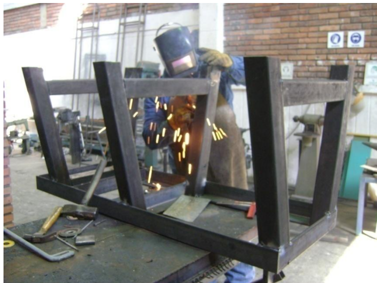
Figura 72. Soldado de la estructura.
