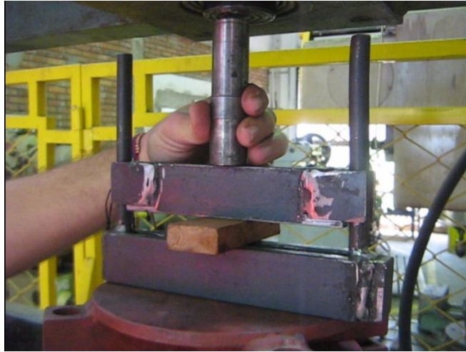
Figura 8. Probeta y mecanismo para el ensayo de cortante.
