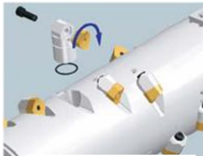
Detalle del eje triturador
