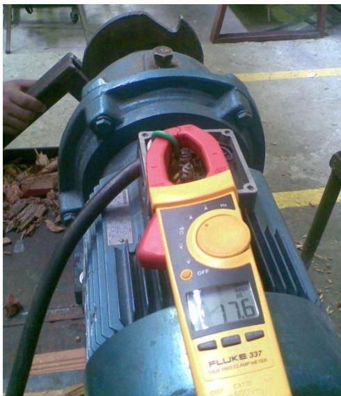
Figura 14. Valor máximo de corriente durante el trabajo.
