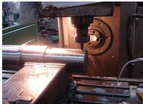
Figura 65. Mecanizado del cuñero.
