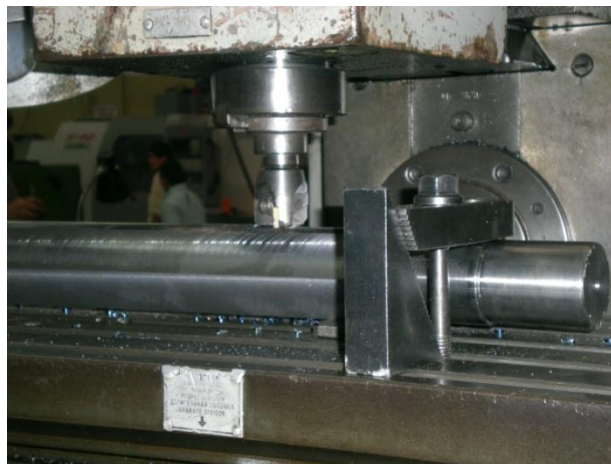
Figura 62. Mecanizado de los ejes.
