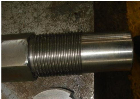
Figura 64. Detalle de la rosca del eje conductor.
