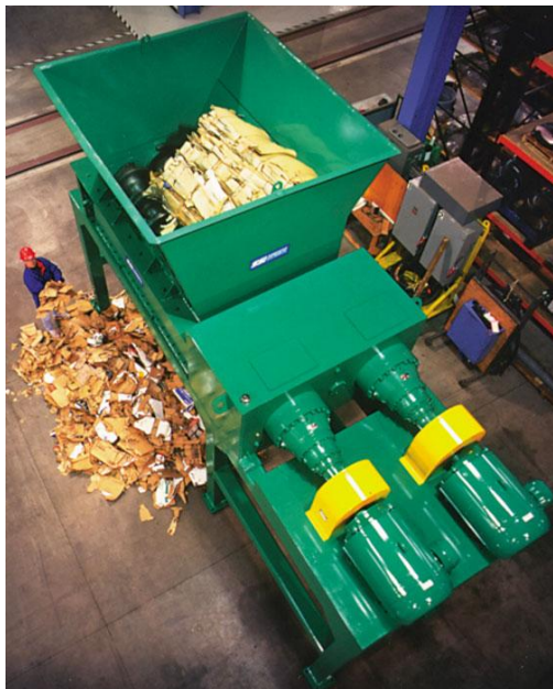
Figura 5. Trituradora de Madera Modelo M160. SSI Shredding Systems, Inc.
