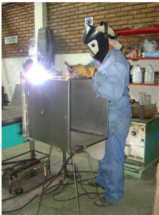
Figura 75. Ensamble de la tolva.
