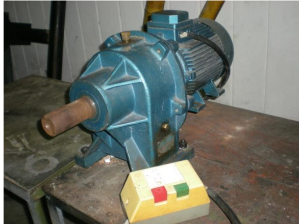
Figura 9. Motorreductor usado en la simulación.
