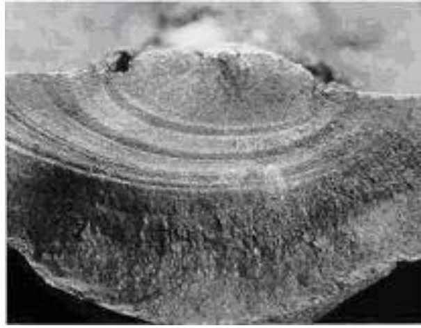
Figura 28. Superficie de fractura por fatiga de una tubería de acero al carbono.
