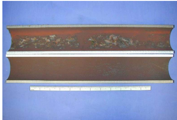
Figura 33. I.D. depósitos en el tubo de la caldera CS con daños por corrosión cáustica.
