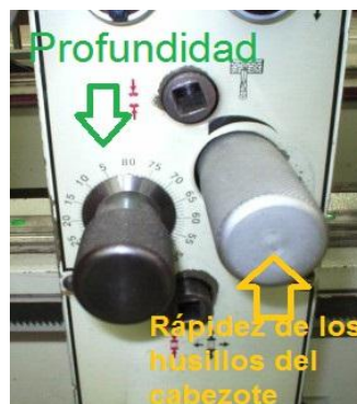
Figura 39. Dispositivo de profundidad para los cabezotes
