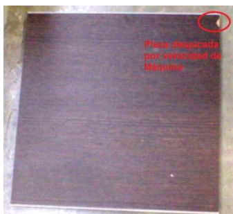
Figura 30. Pieza despicada por el retestador de la máquina y velocidad
