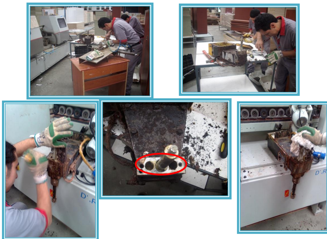
Figura 45. Limpieza profunda del calderín por parte del técnico de mantenimiento y operario de la máquina.
