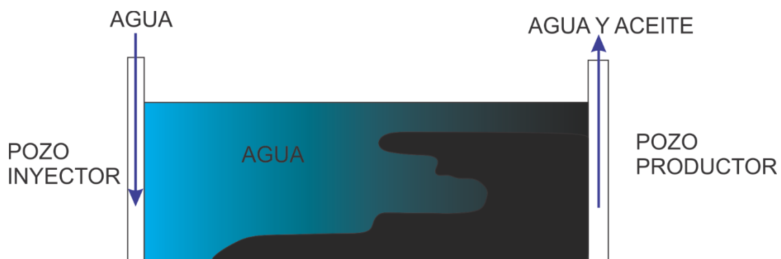
Figura 3. Proceso típico de recobro secundario. Adaptado de Lyons, Plisga, y Lorenz (2016).
