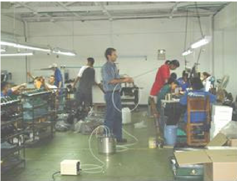
Figura 12. Muestras de aire al interior de la fábrica de calzado en: El aire alejado de los recipientes de pegamento (A) y Zona de respiración de los trabajadores (B).
