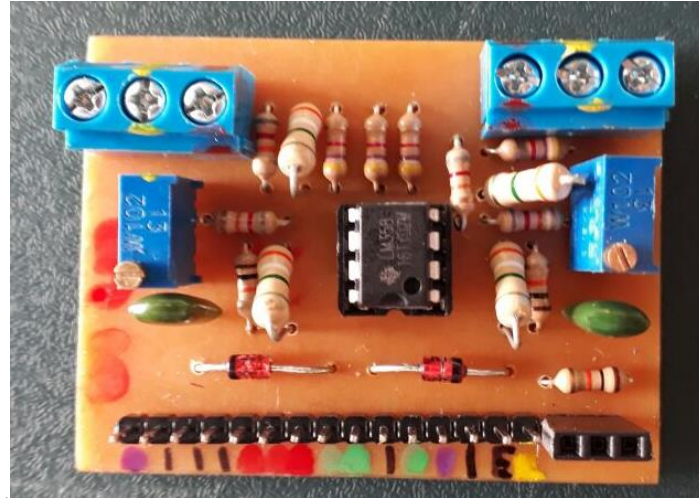
Figura 9. Circuito de adecuación para RTD
