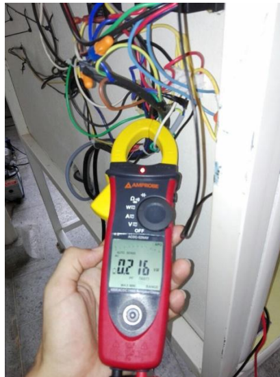
Figura 30. Toma de corriente del banco de pruebas con la pinza amperimétrica
