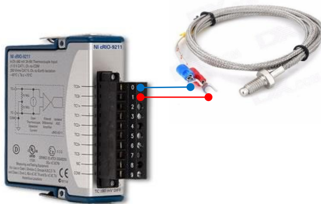
Figura 26. Conexión termocupla tipo J con NI cRIO-9211
