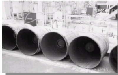
Vista de las botellas pequeñas de HFC-134a después de retirar el refrigerante CFC-12 y de cortar los recipientes principales para abrirlas
