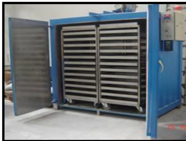
Figura 10. Horno deshidratador industrial.
