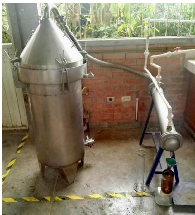
Figura 6. Alambique convencional para destilación de AE, ubicado en el complejo CENIVAM, UIS.
