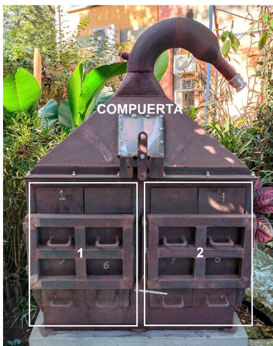
Figura 8. Alambique por compartimientos para destilación de AE, ubicado en el complejo CENIVAM, UIS. 1). Primer bloque de celdas; 2). Segundo bloque de celdas.
