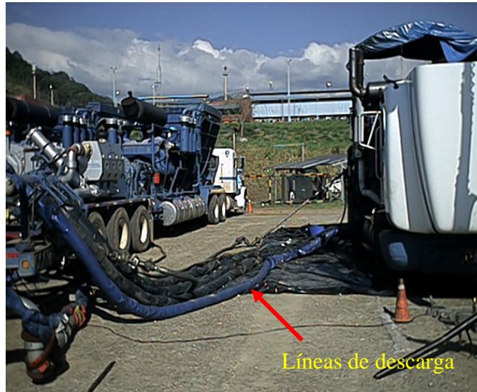
Figura 106. Líneas de la bomba de descarga que llevan los fluidos al manifold de descarga o succión de los fracturadores
