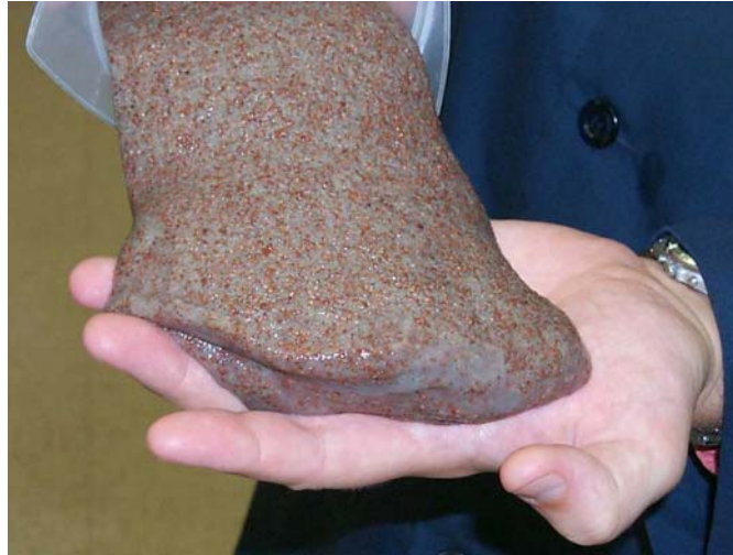
Figura 23. Fluido de fracturamiento mezclado con el material de soporte formando una lengua sostenida
