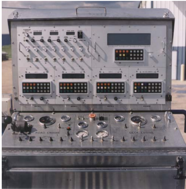
Figura 108. Panel de control utilizado por el blenderista para controlar los materiales involucrados en el proceso de fractura
