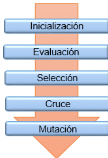
Figura 18. Representación gráfica del esquema general del Algoritmo Genético.
