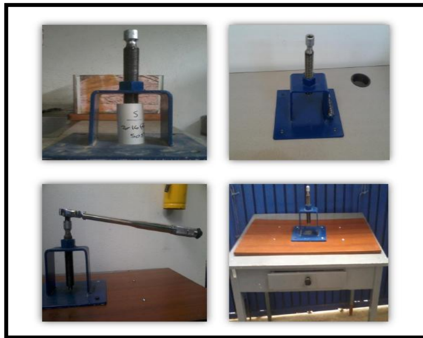
Figura 10. Montaje para la construcción de núcleos sintéticos con torquímetro.
