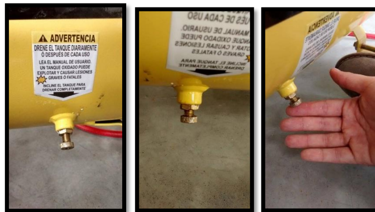
Figura 32. Válvula de Drenaje (Purga)
