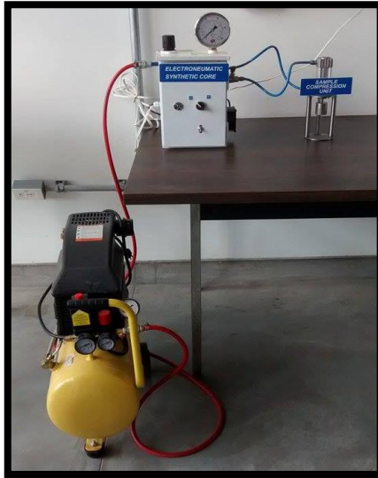
Figura 23. Equipo construido e instalado
