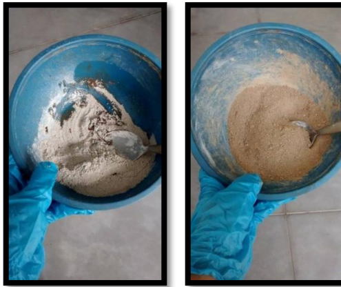
Figura 61. Mezcla de arena y caolín en solución epóxica
