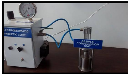
Figura 28. Acople del molde al equipo
