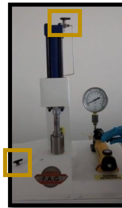
Figura 73. Bombeo para levantamiento del pistón
