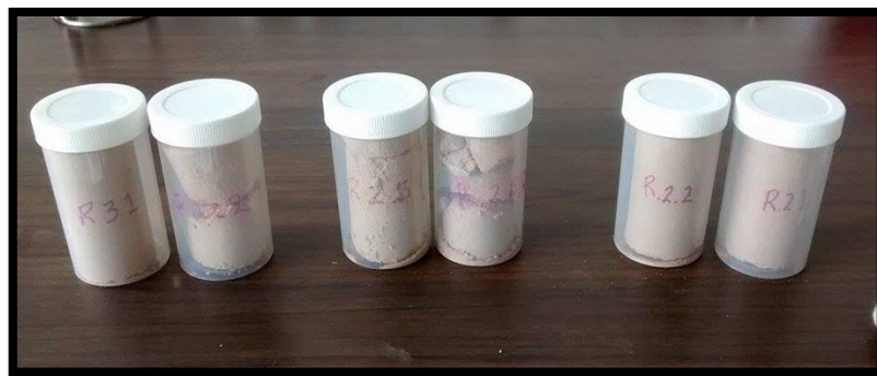
Figura 40. Muestras sintéticas con diferentes relaciones de solución epóxica con mayor cantidad de Resina
