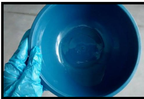
Figura 60. Mezcla de resina y endurecedor
