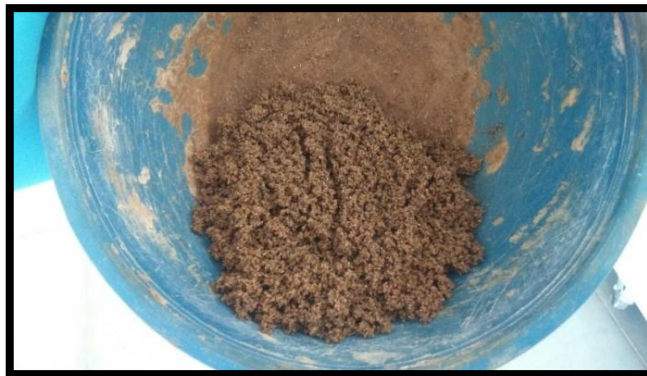
Figura 45. Muestras sintéticas construidas para verificar consolidación
