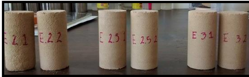
Figura 41. Muestras sintéticas con diferentes relaciones de solución epóxica mayor cantidad de Endurecedor
