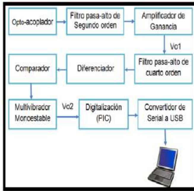
Figura 36. Diagrama de bloques para fotoplestimógrafo. Tomado de: Celi, G. & Rocha, M. & Yapur, Miguel. (2011). Mediciones fotoplestismográficas.
