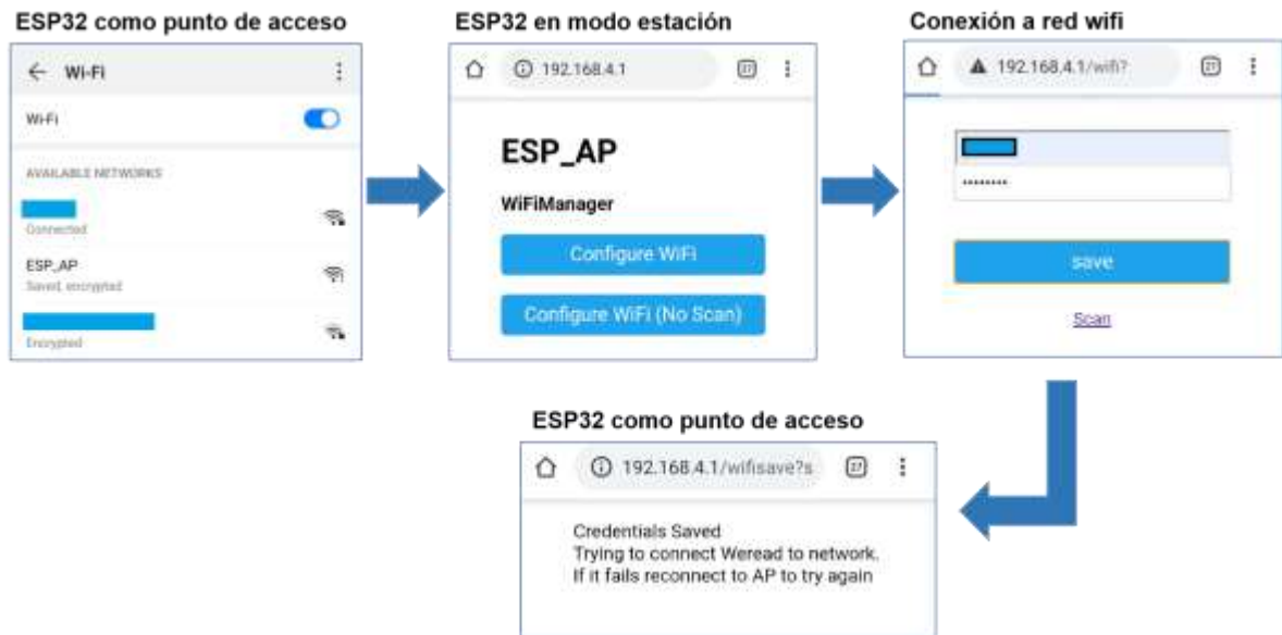
Figura 24. Proceso para conectarse a una red mediante wifi mánager.
