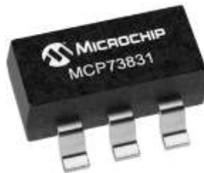
Figura 11. Controlador de gestión de carga MCP73831.
