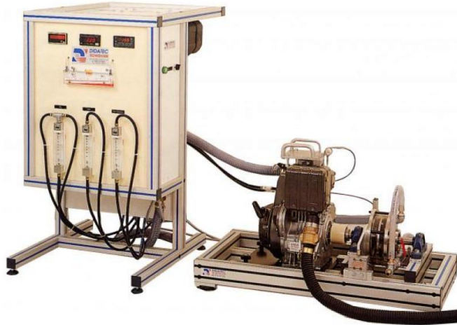
Figura 6. Banco de pruebas de motores de combustión interna
