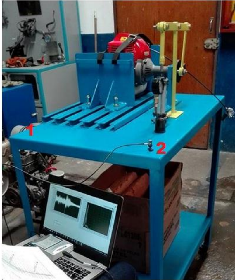
Figura 61. Pruebas de vibraciones al banco de pruebas de motores 2T
