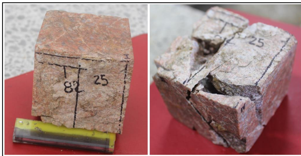
Figura 77. Cubo de roca granítica antes y después del ensayo de compresión uniaxial.
