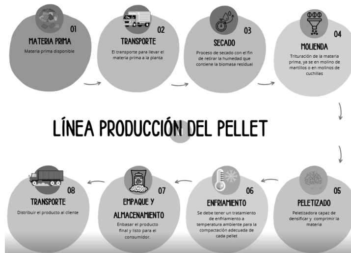
Figura 20. Esquema de Producción para los Pellet
