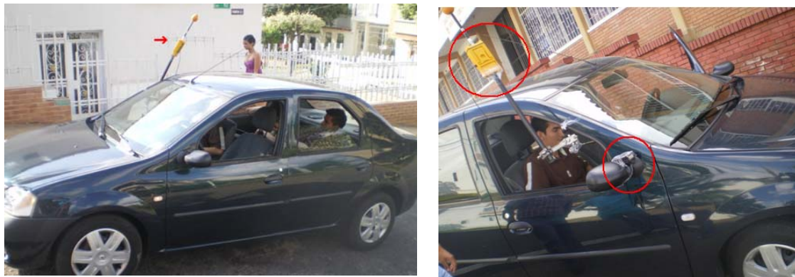
Figura 21 Instrumentos de medición instalados sobre el vehículo
