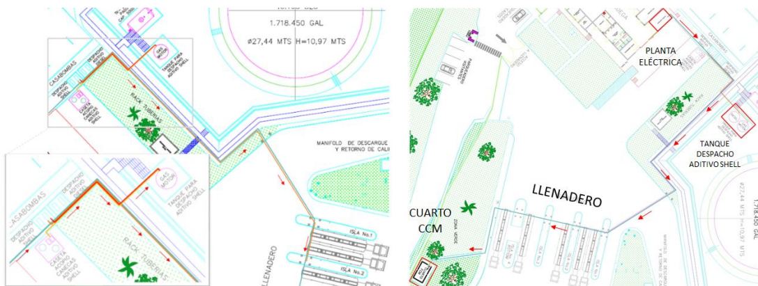
Figura 15 Planimetría tubería de conducción aditivo V-Power
