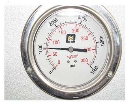
c) Presion del sistema oleohidraulico para el sellado del accesorio tipo reduccion.
