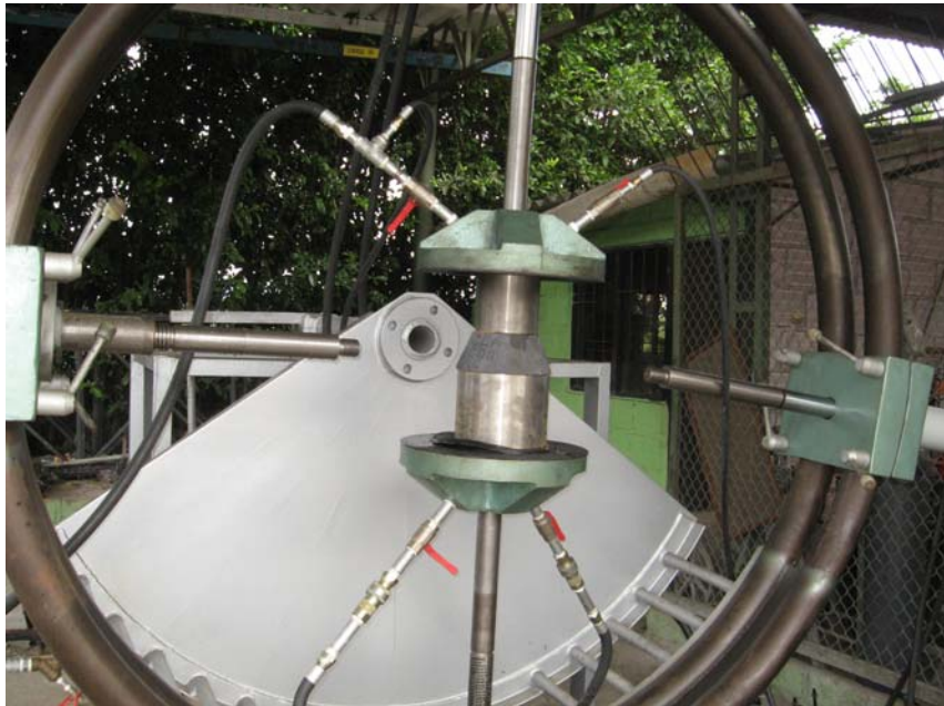
Figura 107. Prueba a accesorio tipo Reducción 6" X 4".
