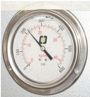
a) Presion de prueba hidraulica del accesorio tipo reduccion
