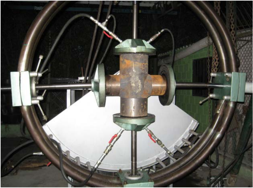
Figura 111. Prueba accesorio tipo cruz de 8" X 6".
