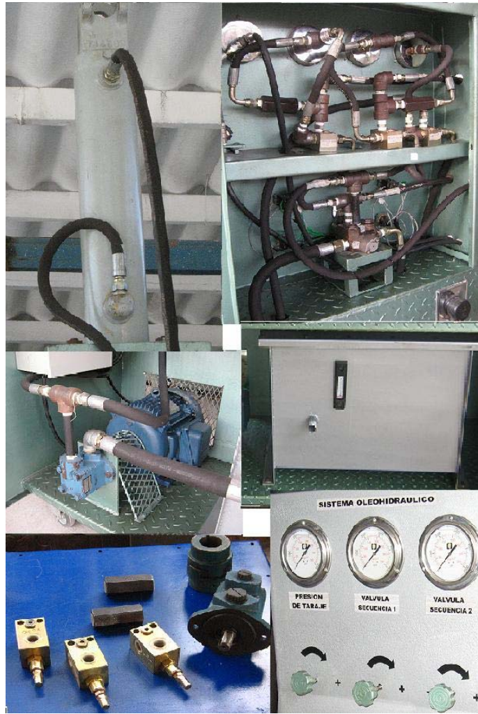
Figura05 principales partes constitutivas del sistema oleohidráulico.
