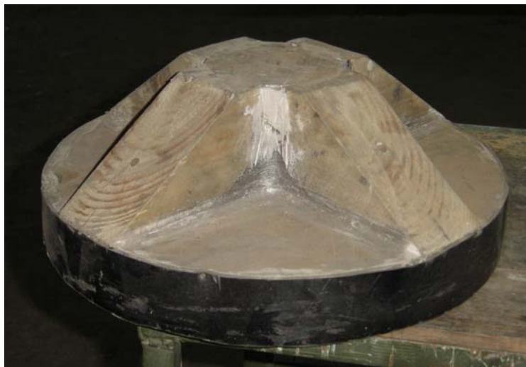
Figura 94. Modelo en madera para moldeo en arena de tapón alimentador
