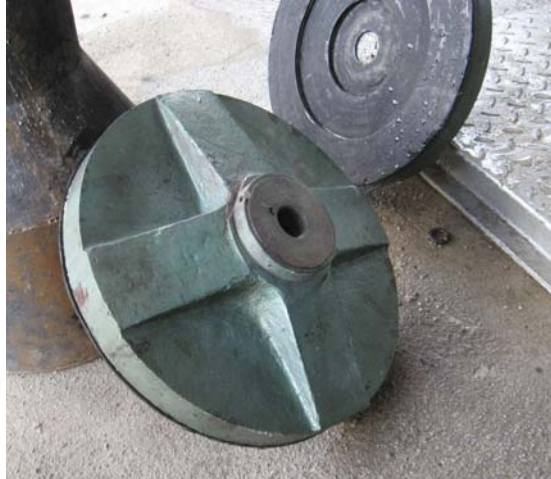
Figura 98. Tapón ciego listo para montaje con detalle de empaques pegados para mejorar el sello con el accesorio
