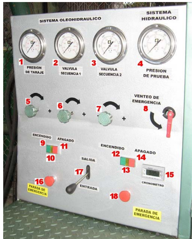
Figura 03. Elementos constitutivos del tablero de control.
