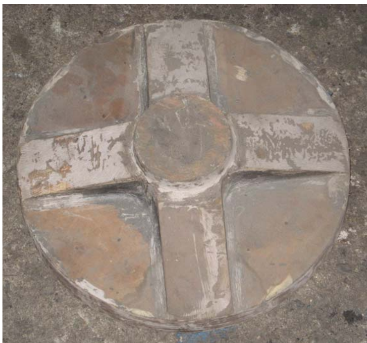
Figura 95. Modelo en madera para moldeo en arena de tapón ciego
