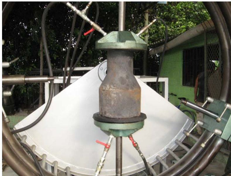
Figura 13. Ejemplo de montaje correcto para accesorios tipo reducción 9.1.2 Montaje de accesorios tipo codo a 11.25 grados.
