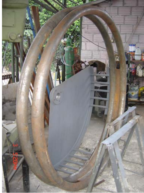
Figura 90. Fabricación del conjunto soporte aros
