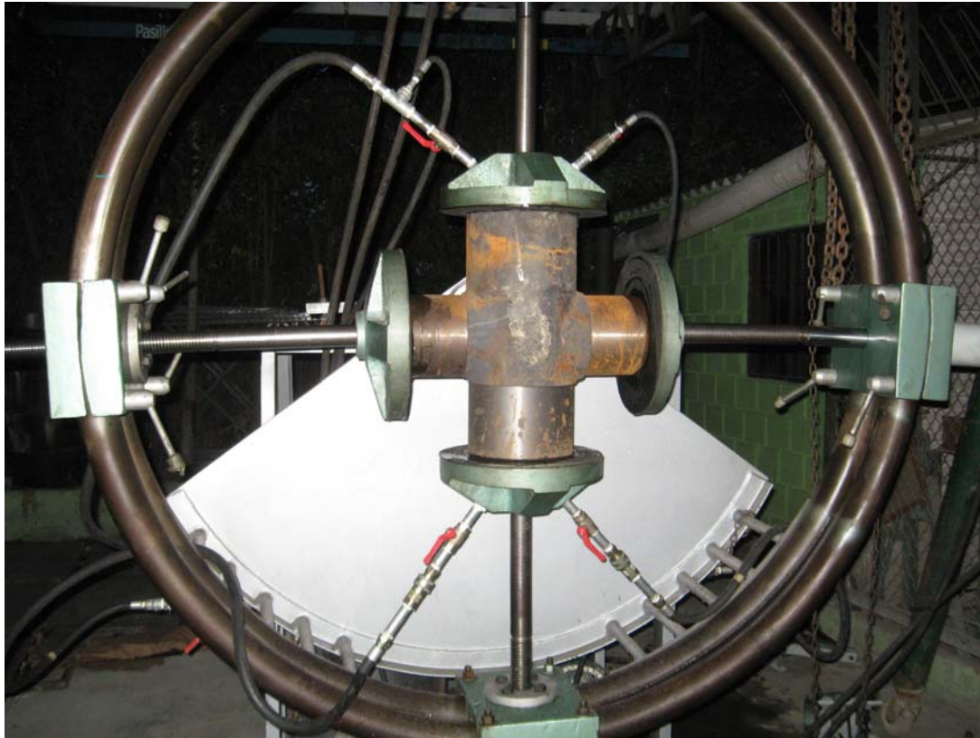
Figura 25. Esquema de montajes accesorios tipo Cruz
