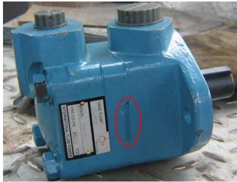
Figura 01. Flecha indicadora del sentido de giro de la bomba oleohidráulica
