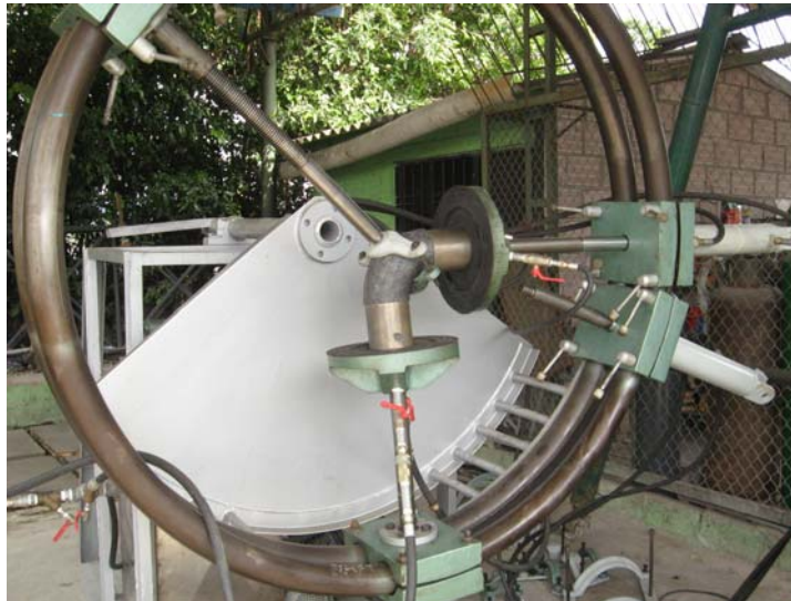
Figura 110. Presión de trabajo en el sistema hidráulico y del sistema oleohidráulico para la prueba de un accesorio tipo codo a 90 grados de 4\".
