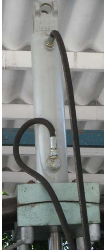
Figura 101. Cilindro oleohidráulico remanufacturado en posición de trabajo vertical
