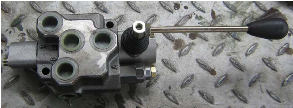
Figura 75. Válvula direccional del sistema oleohidráulico
