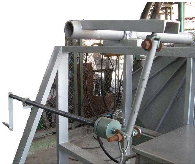
Figura 09. Elementos del sistema de posición manivela y corredera
