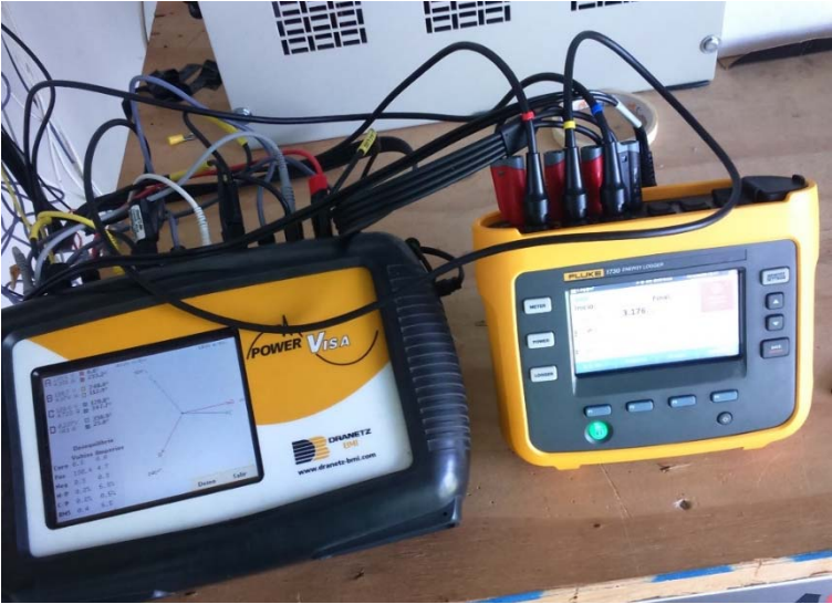
Ilustración E4. Medidores DRANTZ POWER VISA Y Fluke 1730.
