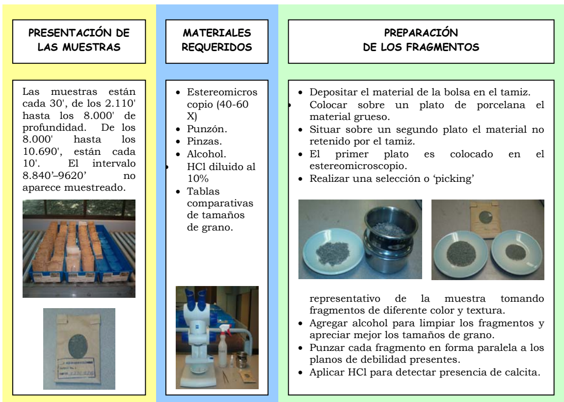
Figura 16. Procedimiento utilizado para la descripción de las muestras de zanja seca del Pozo Pivijay-1.
