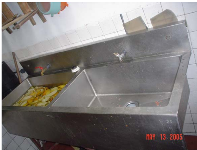
Foto 2. Tanques de lavado de la guayaba
