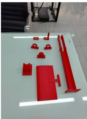
Figura 80. Piezas 3D elaboradas con filamento de PLA. Fuente: Elaboración propia.
