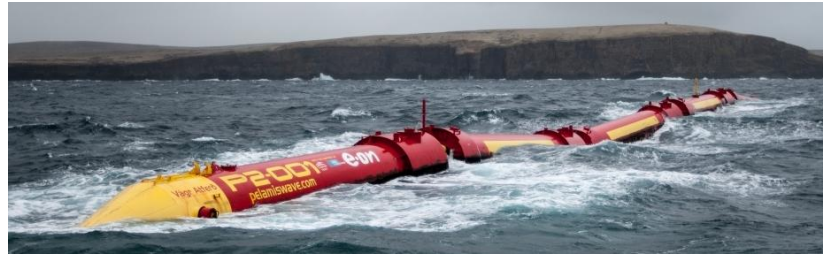
Figura 1. Convertidor de energía de olas Pelamis en funcionamiento. Fuente: EMEC (s.f.)
