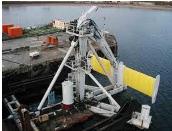
Figura 3. Puesta en marcha de la hidro ala oscilante Stingray. Fuente: The Engineering Bussiness Lmt. (2005)
