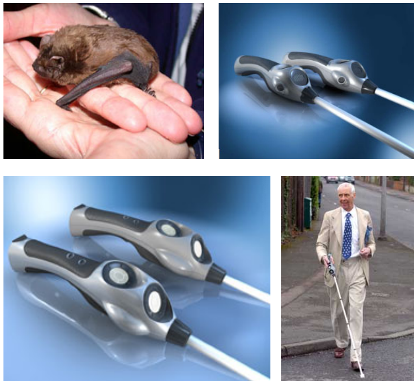
Figura 2. Bastón con ondas ultrasónicas
