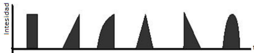
Figura 7. Corriente galvánica interrumpida
