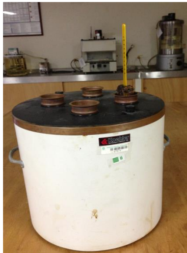
Equipo para medición de punto de fluidez. Laboratorio de fluidos, Escuela Ingeniería de Petróleos – UIS.
