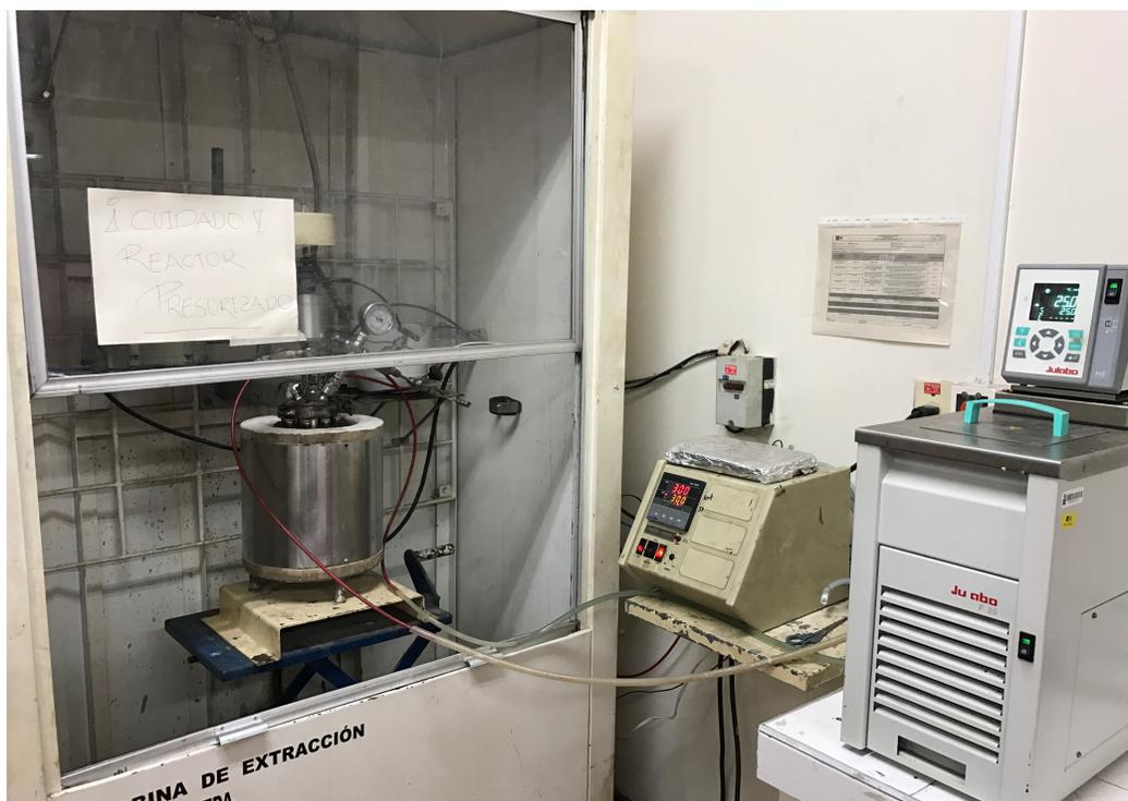
Previo a la toma de muestra se le realizaba vacío al cilindro con el fin de facilitar la extracción de los gases del reactor al cilindro de muestreo, figura 20.
