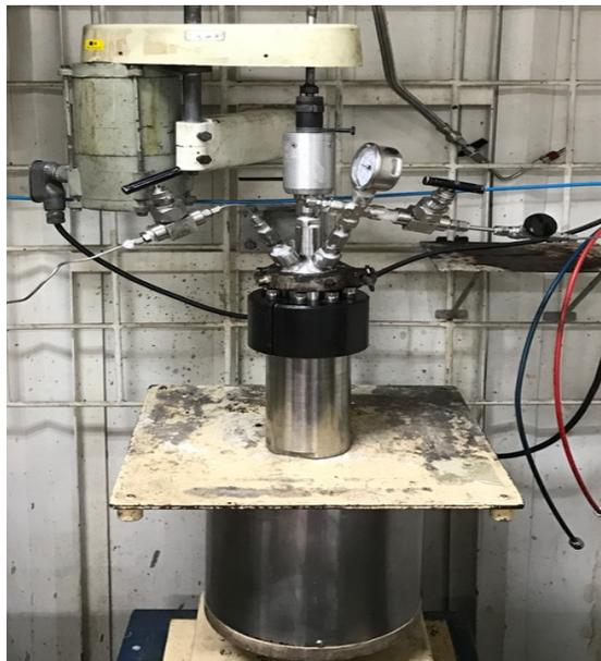
La presión del sistema corresponderá a la presión autógena obtenida durante la estabilización del sistema de reacción a la temperatura de prueba, así pues, se podrán recolectar al final de cada ensayo los gases efluentes a través de un
