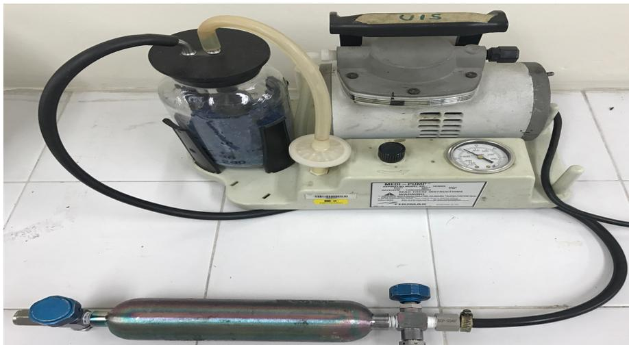
Seguidamente se realizaba el acople del cilindro a la línea de salida de gases, a través de una conexión rápida que permitía realizar la recolección de los gases de manera ágil y segura, figura 21.
