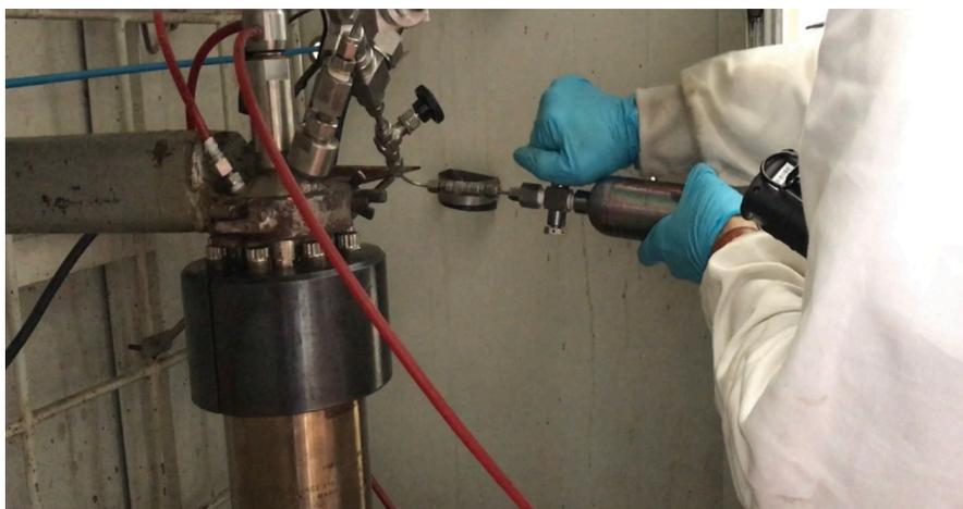
Al culminar la recolección de los gases producto de la reacción, se procedía a llevar la muestra de gases al laboratorio de cromatografía del Instituto Colombiano del Petróleo (ICP), con el fin de analizar la composición del fluido empleando un
