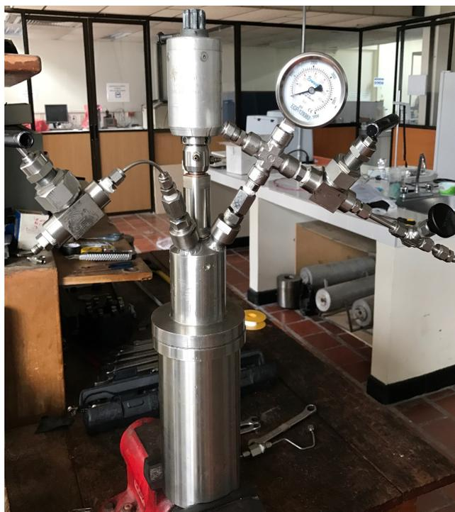
Seguidamente se sitúa una abrazadera cerámica que mantiene unidas el cabezal y el vaso del reactor y finalmente se ajustan los pernos empleando un torquímetro calibrado a 50 lb/pie, figura 17.
