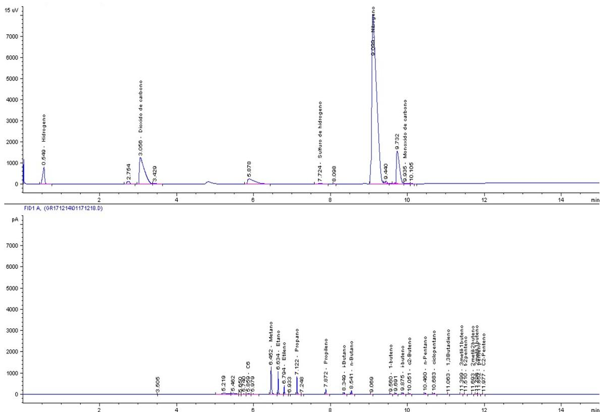
Figura 24. Cromatograma prueba 518°F.
