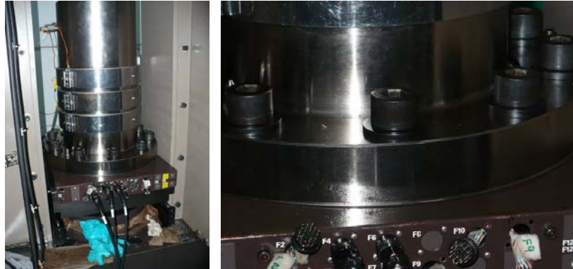
Figura 103 Aseguramiento De Campana Del Equipo MTS 815
