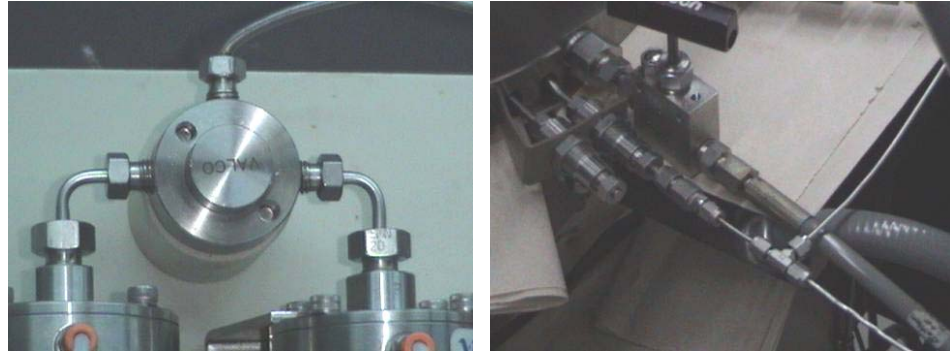
Figura 101 Conexión Bomba ISCO Equipo MTS 815
