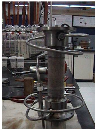
Figura 98 Ajuste De Funda Termoencogible
