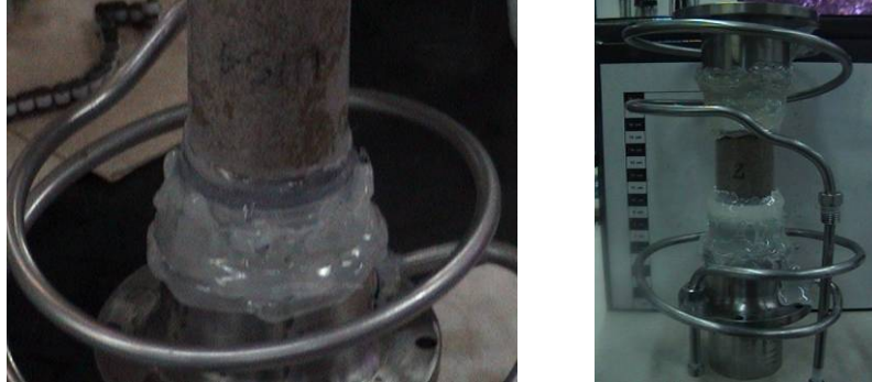
Figura 99 Aplicación De Silicona Al Montaje
