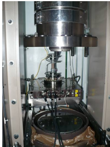
Figura 102 Ubicación De La Probeta En El Equipo MTS 815
