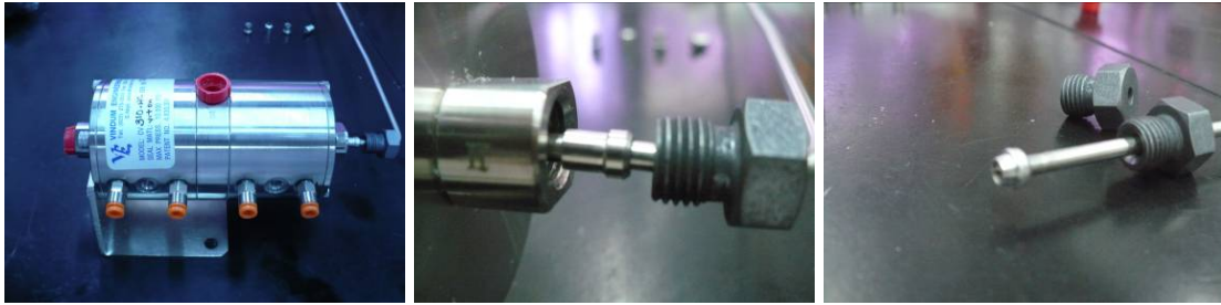
Figura 88 Conexión Tubing - Válvulas
