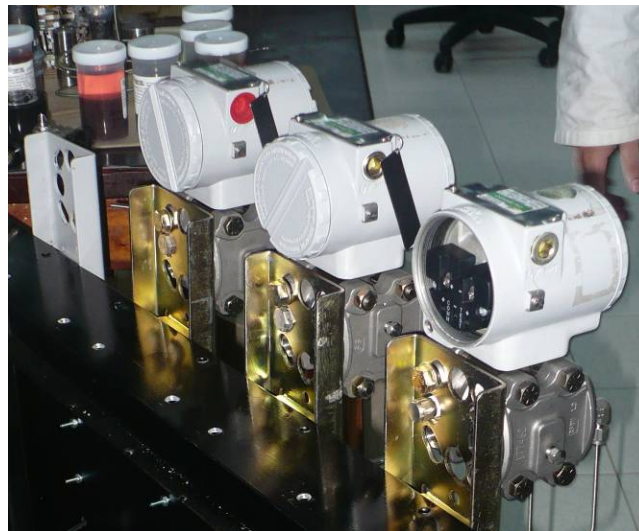
Figura 37 Detalles Montaje De Los Medidores De Presión Diferencial
