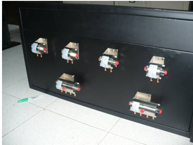
Figura 82 Montaje de Válvulas Hidráulicas
