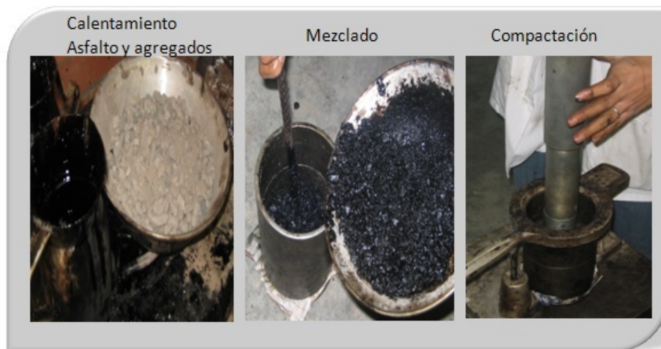
Fotografía 2.12. Proceso de compactación
