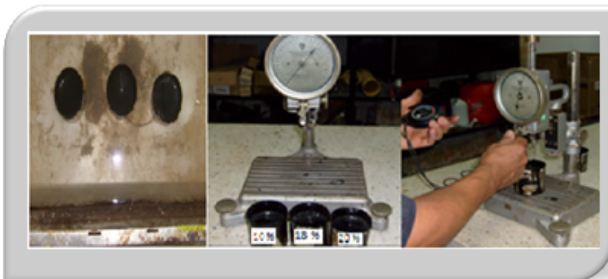
Fotografía 2.5. Esquema ensayo de Penetración
