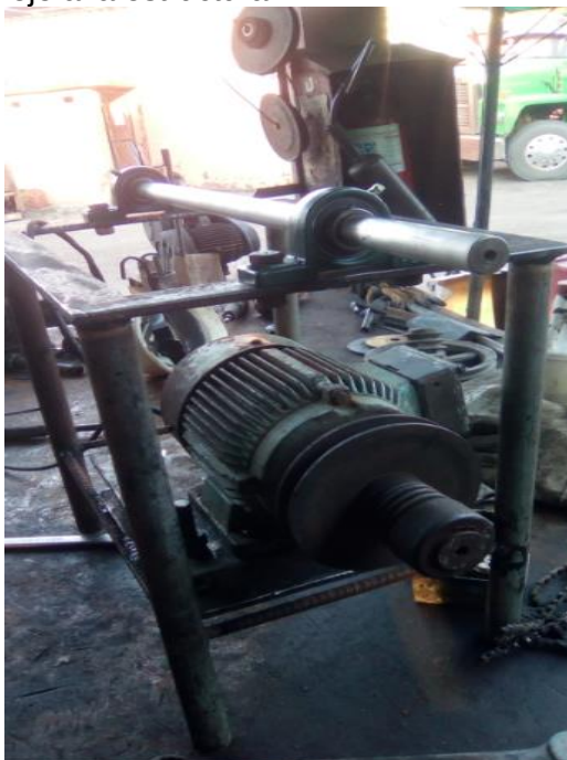
Figura 49. Instalación del eje a la estructura
