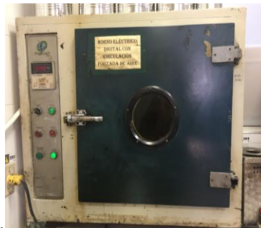
Figura 56. Horno eléctrico de tiro forzado
