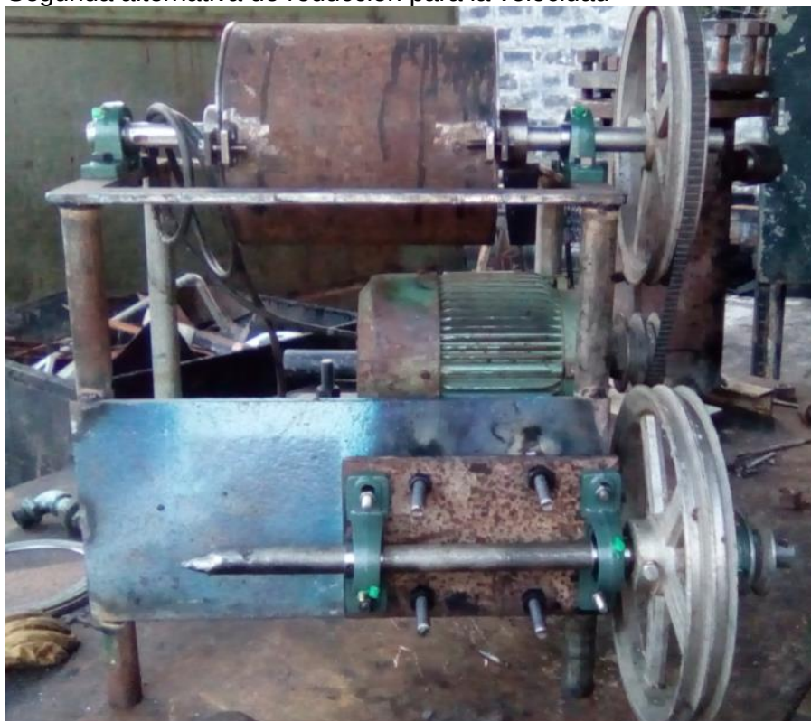
Figura 53. Segunda alternativa de reducción para la velocidad
