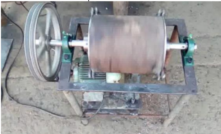
Figura 52. Prueba de velocidad de la primera transmisión
