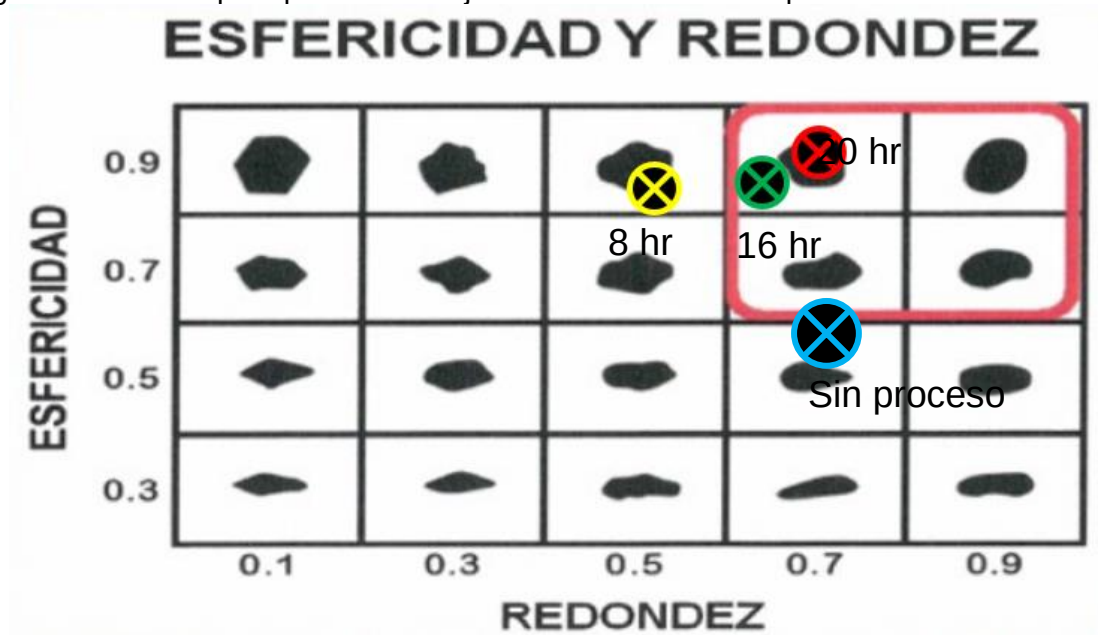
Figura 90. Análisis para proceso con lija #80 con diferente tiempo.
