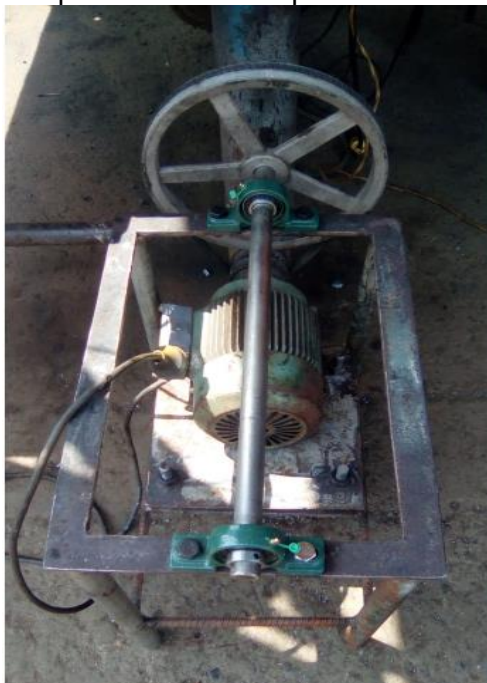
Figura 50. Primera alternativa para la reducción para la transmisión
