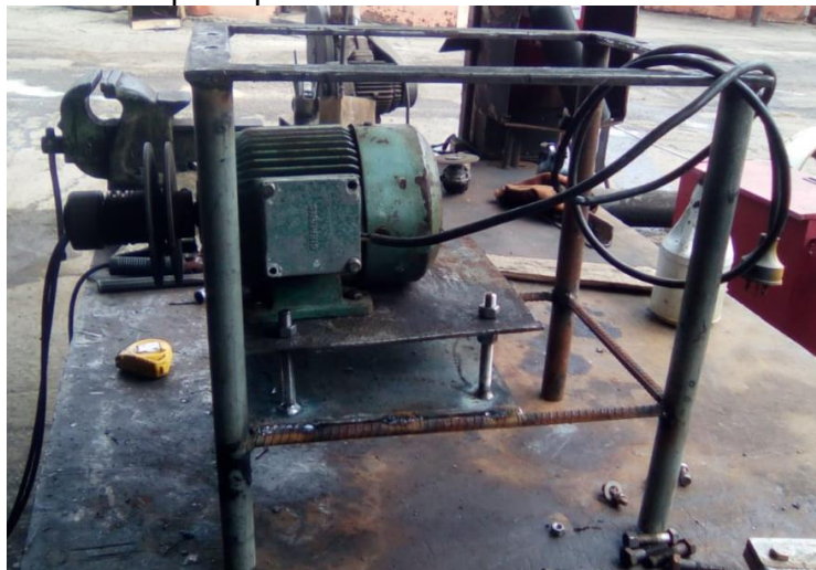
Figura 48. Estructura con soporte para el motor
