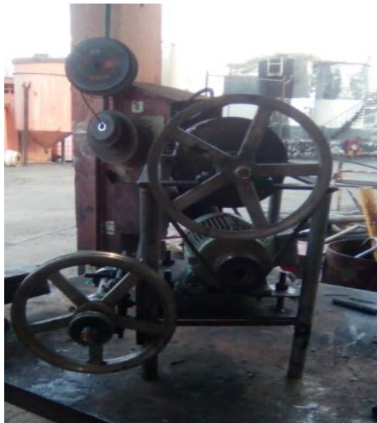
Figura 54. Instalación de las correas
