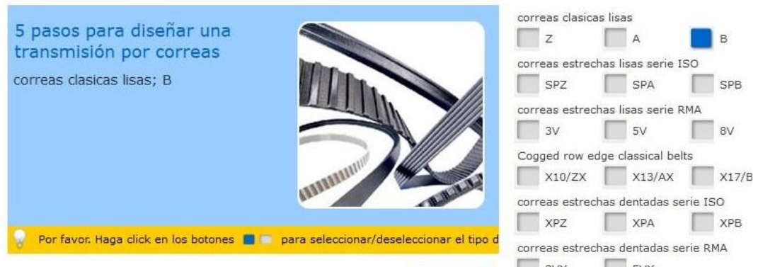
Figura 30. Entrada de datos para selección de la correa SKF, para la transmisión que va del eje auxiliar al eje del cilindro.
