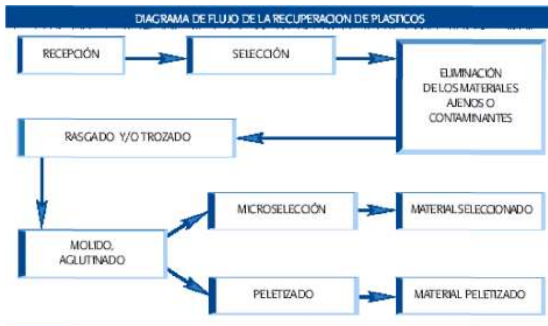
Figura 3. Diagrama de flujo de la recuperación de plásticos.
