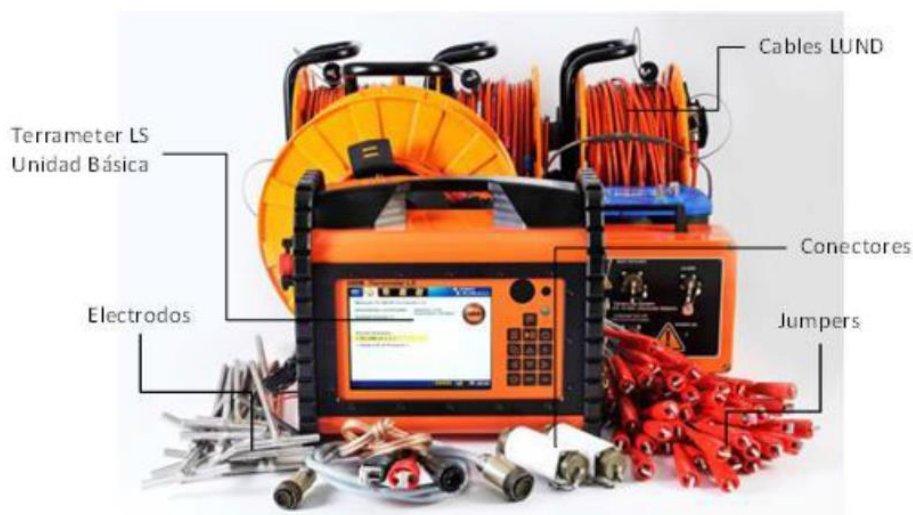
Figura 24. Equipo utilizado para la medición de los datos de resistividad.
