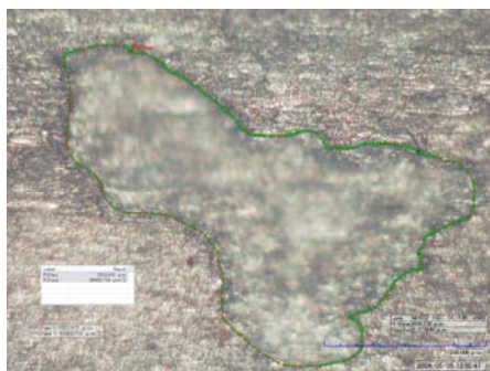
Fotografía 12. Área del picado 3% Cl - 560X
