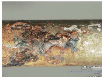
Fotografía 6. Productos de corrosión 2.5% Cl - 50X
