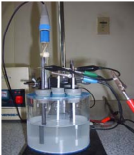
Fotografía 3. Montaje de la celda (a) – Conexión del potenciostato (b) (3a) (3b)
