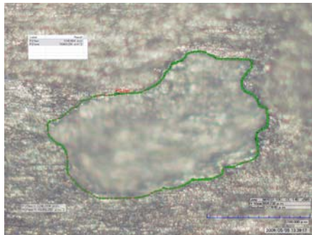
Fotografía 16. Área del picado 3.5% Cl - 560X
