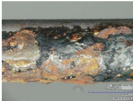
Fotografía 10. Productos de corrosión 3% Cl - 50X
