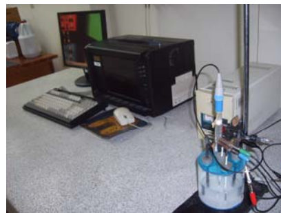
Fotografía 3. Montaje de la celda (a) – Conexión del potenciostato (b) (3a) (3b)
