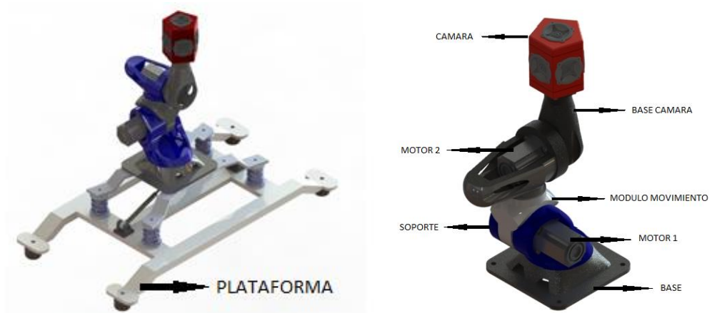
Ilustración 7. Funcionamiento del diseño.
