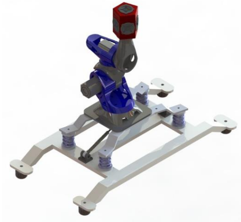
Ilustración 19. Modelo CAD con un soporte de amortiguación.
