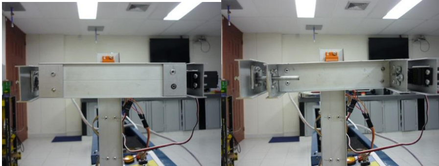
Ilustración 90. Inclinación máxima del ángulo Pitch del prototipo experimental. 13
