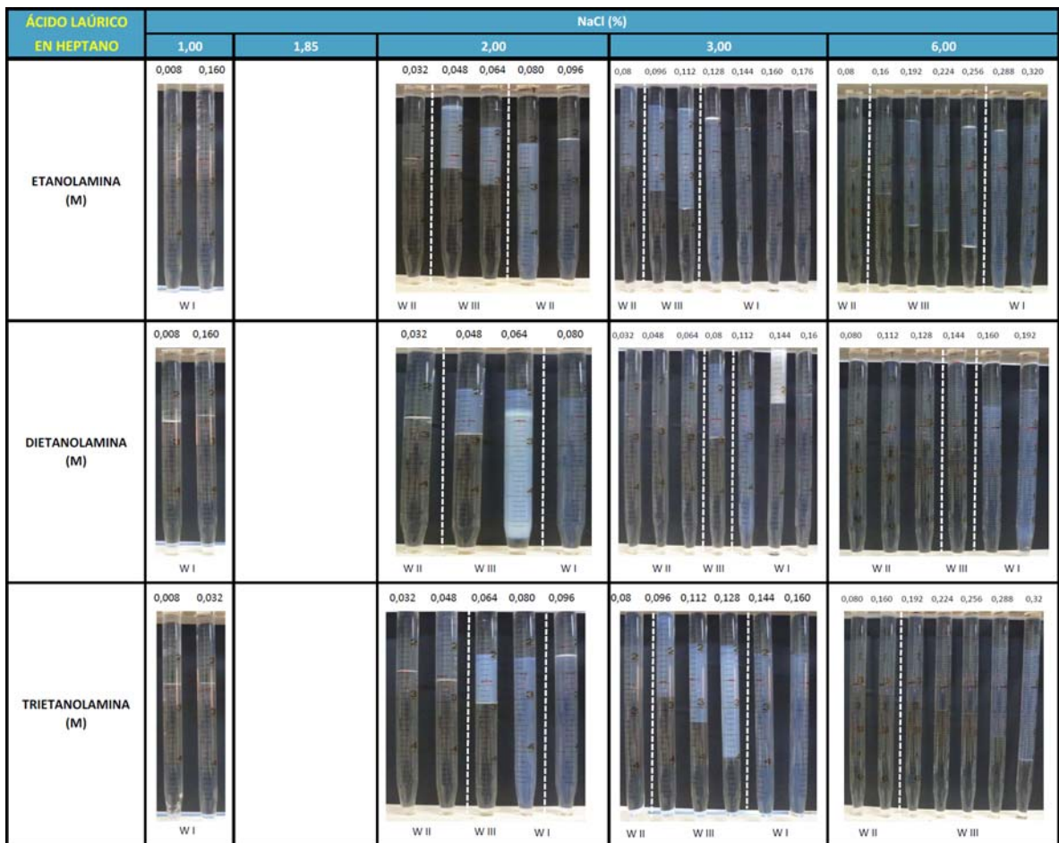
Figura 23. Experimentos de comportamiento de fases utilizando como fase aceite una solución de ácido láurico en heptano (1,0% m/m) y como fase acuosa soluciones de álcalis orgánicos (MEA OH, DEA OH, TEA OH) con concentración variable a diferente salinidad como % de NaCl.
