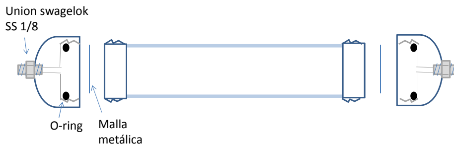
Figura 11. Contenedor del medio poroso empleado en los experimentos de desplazamiento unidimensional.
