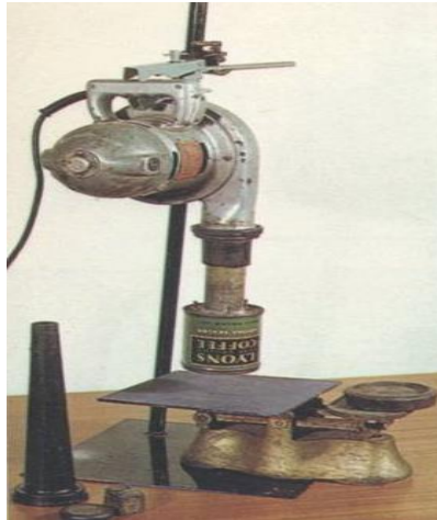
Figura 78. Balanzas con latas concéntricas
