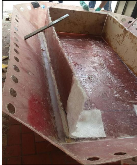
Figura 31. Base interna del casco en fibra de vidrio.
