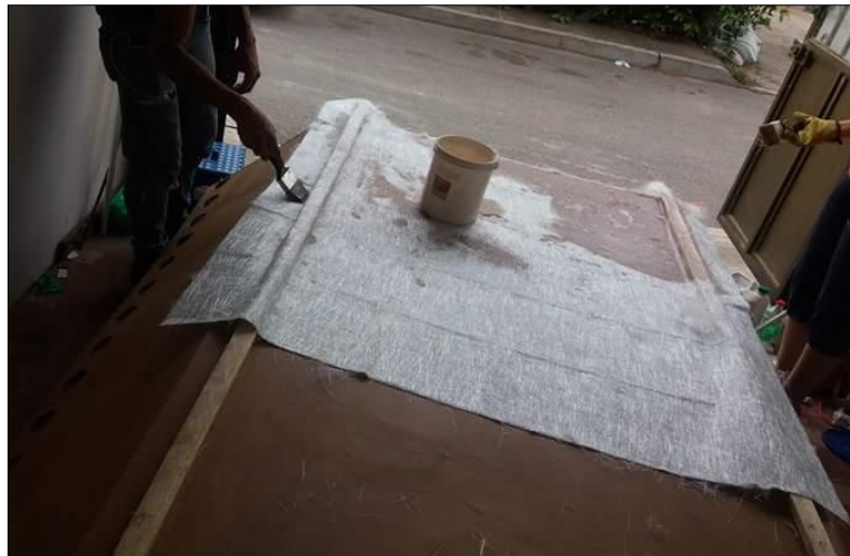
Figura 29. Aplicación de fibra de vidrio sobre el molde en MDF.
