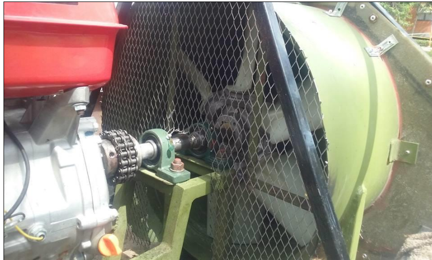
Figura 18. Malla de protección metálica.
