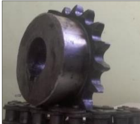
Figura 121. Acoplamiento de cadena seleccionado.
