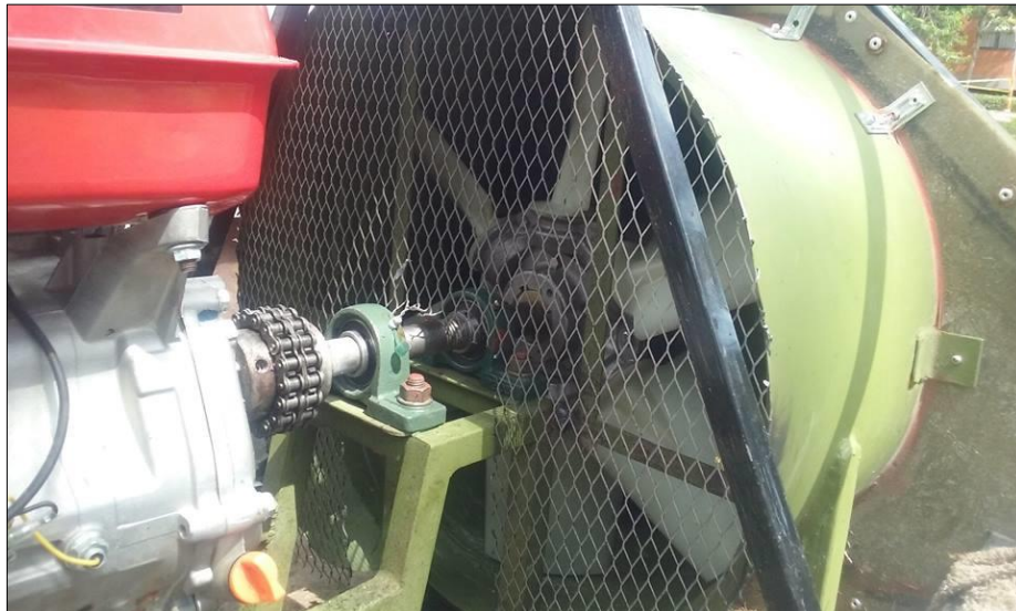
Figura 51. Malla de protección subsistema de sustentación.
