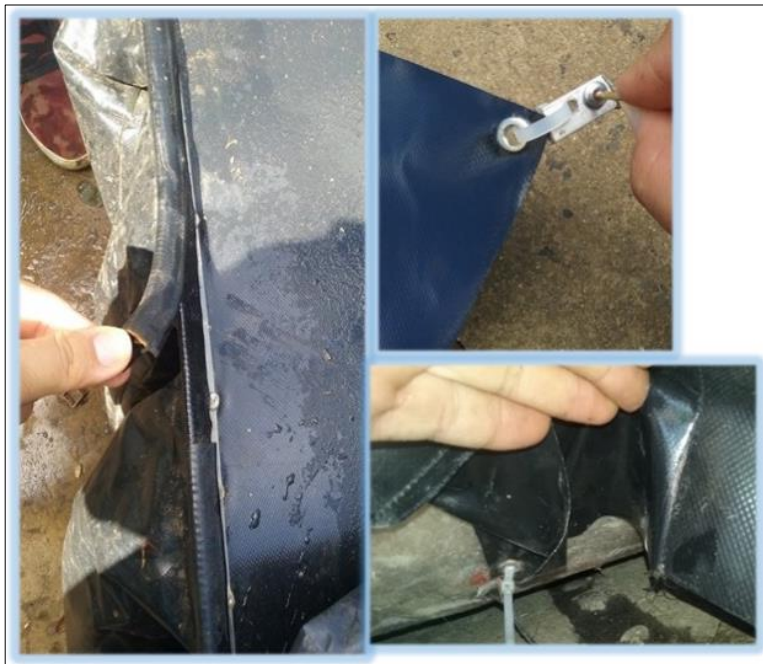
Figura 15. Sujeción de la falda tipo dedo.
