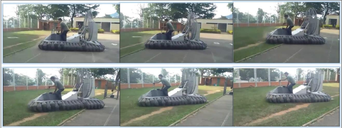
Figura 74. Prueba sobre obstaculo de mediano alcance N°1.
