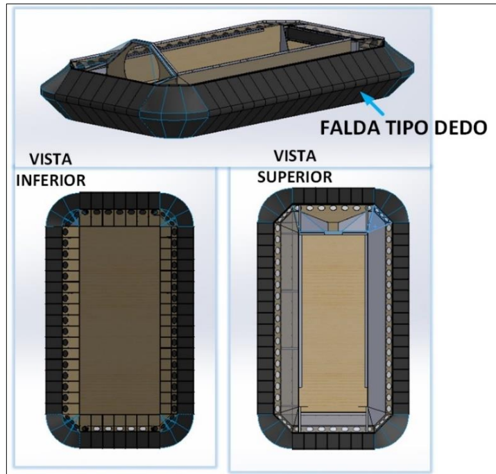
Figura 14. Falda tipo dedo alrededor del casco.
