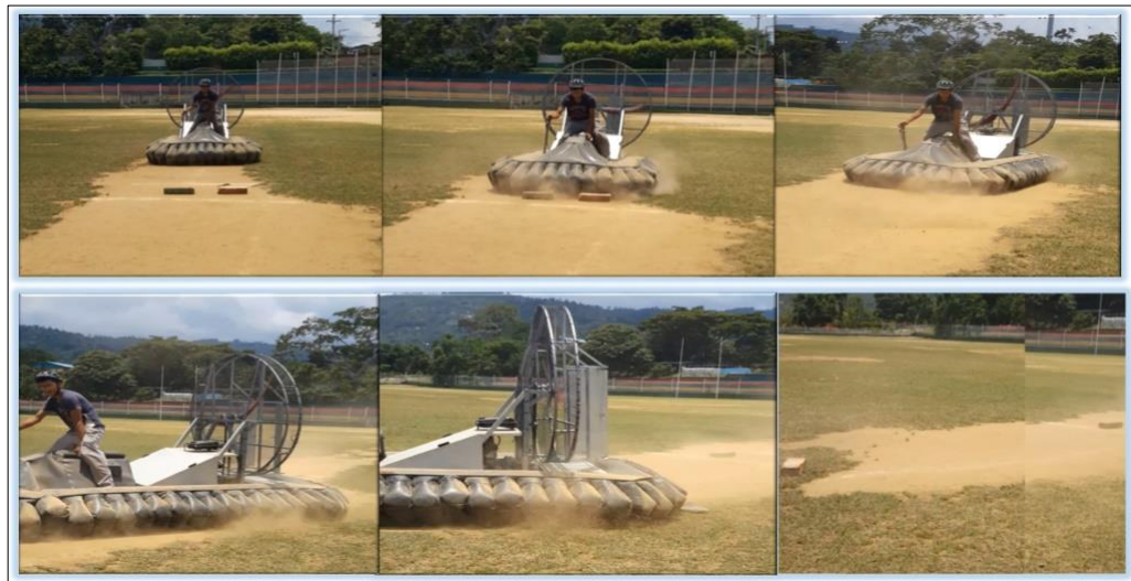
Figura 75. Prueba sobre obstaculo de mediano alcance N°2.
