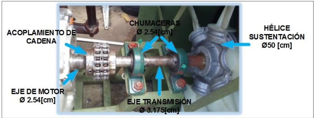
Figura 17. Transmisión de potencia subsistema de sustentación.
