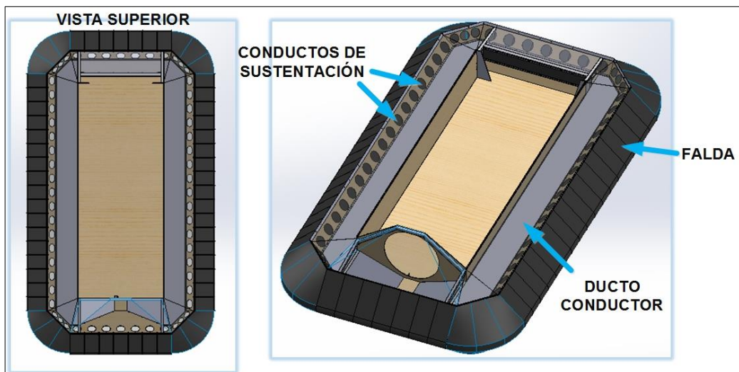
Figura 9.Ducto conductor y conductos de sustentación.
