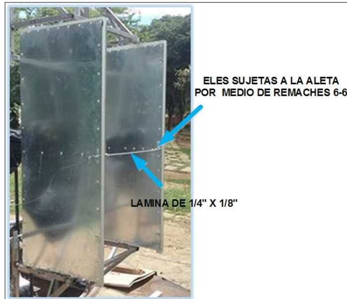
Figura 64.Lamina sujeta a las aletas.
