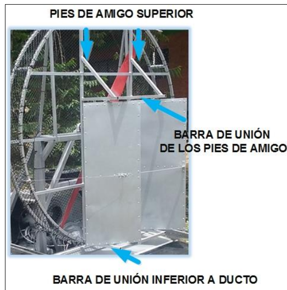
Figura 65. Pies de amigos sujetos al ducto de propulsión.
