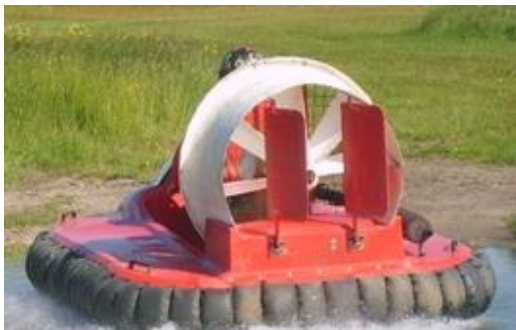
Figura 87. Aletas verticales en un Aerodeslizador
