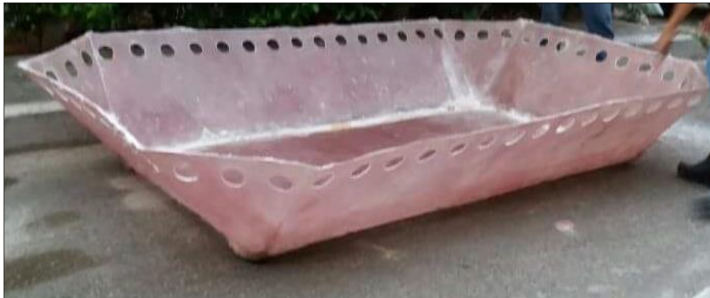
Figura 30. Base exterior del casco en fibra de vidrio.
