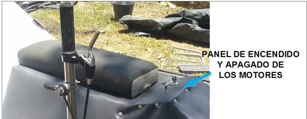
Figura 25. Panel de control para encendido y apagado de motores.
