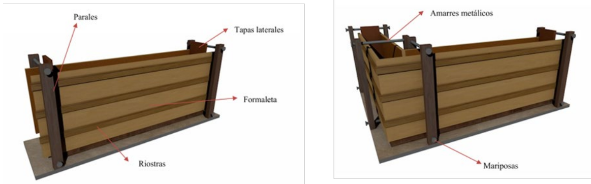
Figura 57. Esquema estructural de tapial tradicional y tapial tipo L.
