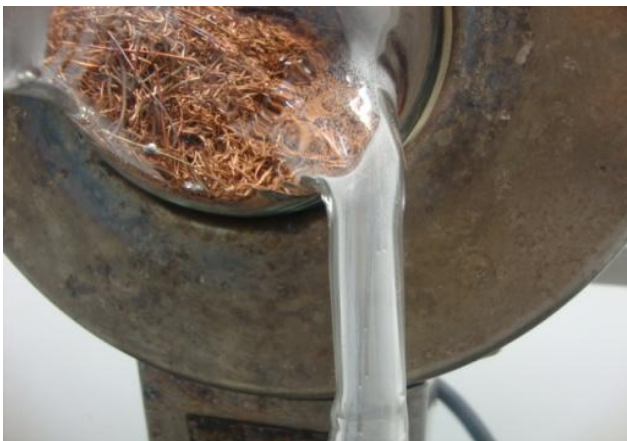
Anexo 11. Montaje para la desorción térmica de mercurio en cobre
