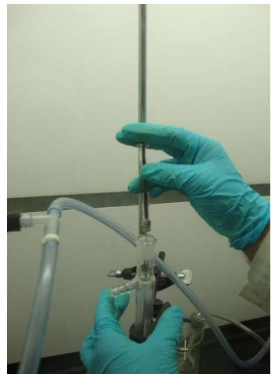
Anexo 13. Primeras señales de desorción y condensación de mercurio en las paredes del sistema
