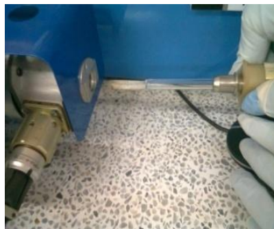
Anexo 33. Porta muestra a la entrada del pirolizador del equipo
