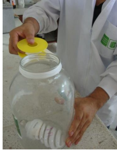
Anexo 19. Adición de Teflón alrededor de la tapa del frasco
