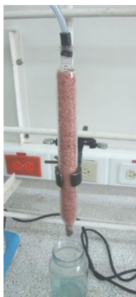
Anexo 3. Lavado del cobre con ácido nítrico diluido
