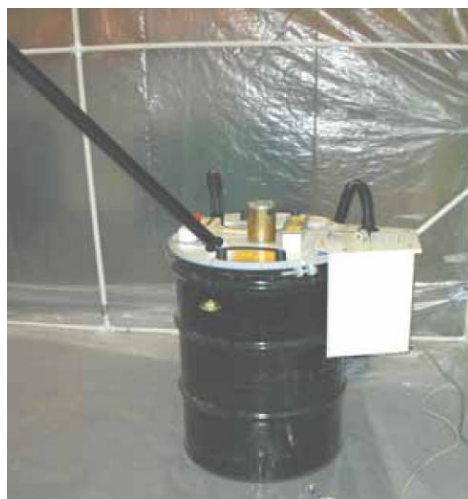
Figura 10. El DRUM-TOP-CRUSHER. Prototipo de pre tratamiento de lámparas con contenido de mercurio.
