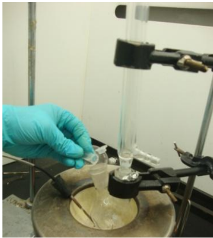
Anexo 16 Adición de mercurio en el sistema sin adsorbente
