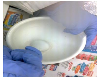
Anexo 29. Trituración del vidrio y polvo fluorescente en un mortero
