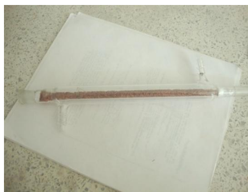
Anexo 4. Vista general de la Columna empacada con cobre
