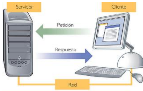
Figura 2. Esquema de Arquitectura Cliente-Servidor de Dos Capas
